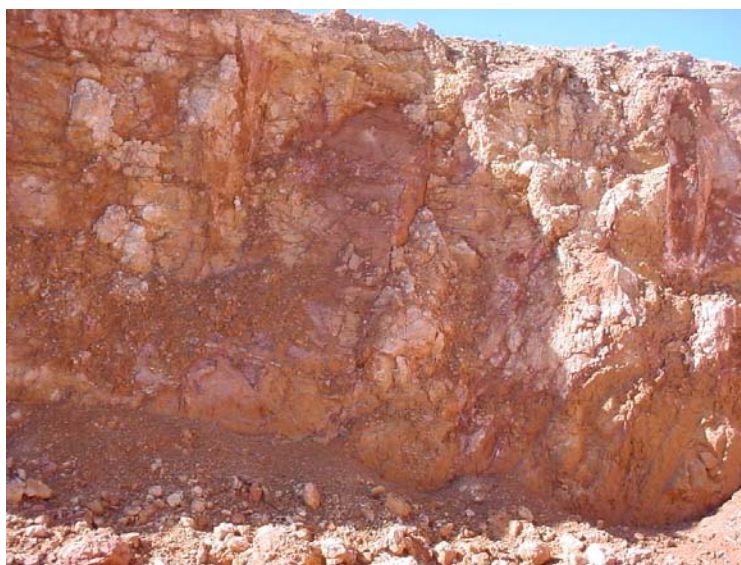
FIGURA 40: Solo saprolítico proveniente dos nefelina-sienitos, coordenadas UTM 7.586.861N e 337.880E.
