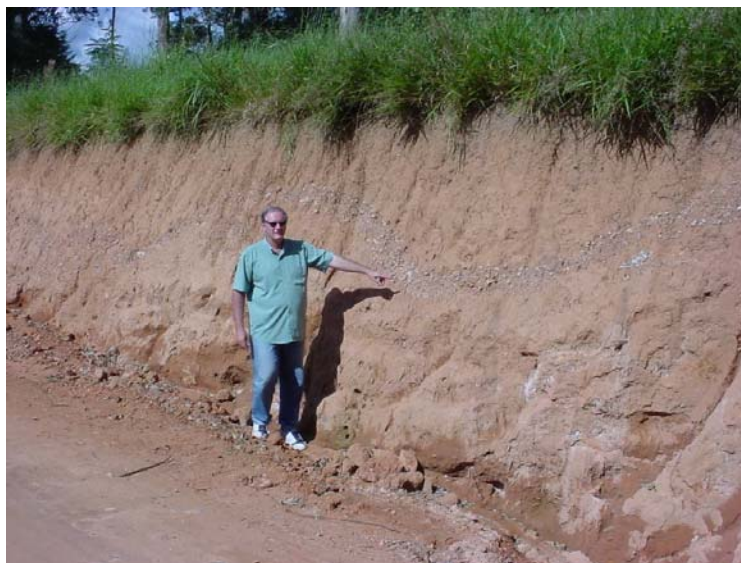
FIGURA 41: Linha de seixo com presença de quartzo, separando solo residual e solo transportado, coordenadas UTM 7.596.767N e 344.765E.
