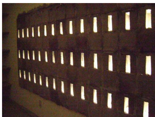
Figura 86. Foto da parede de teste montada com bloco tipo 3 sem lã de vidro (Cs/lã)
