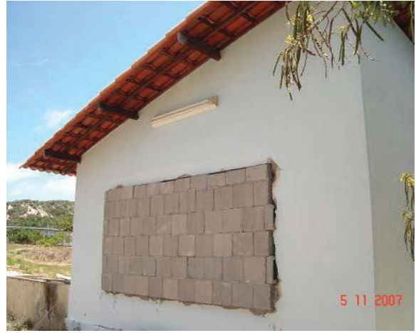
Figura 59. Outra tomada fotográfica da parede de teste montada, sem aberturas, com o bloco tipo 2 (Gfechado)
