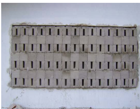
Figura 85. Foto da parede de teste montada com bloco tipo 3 sem lã de vidro (Cs/lã)
