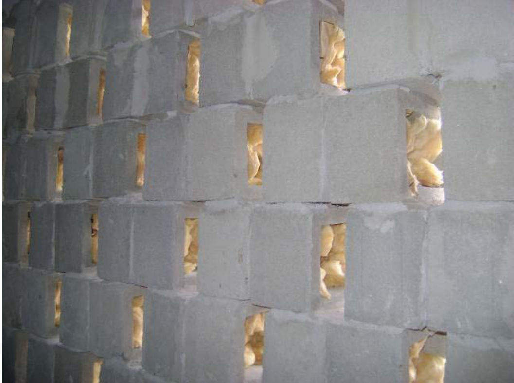
Figura 53. Foto da parede de teste montada com o bloco tipo 1 pequeno (P) espaçados de 5cm e com lã de vidro nas cavidades (P5c/lã)
