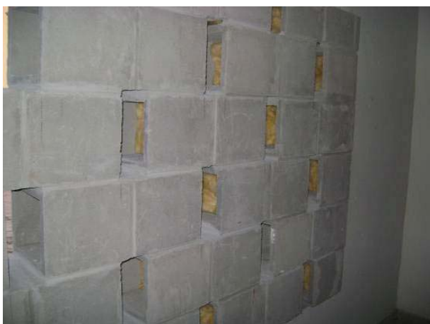
Figura 69. Tomada fotográfica da parede de teste montada com o bloco tipo 2 espaçado 10cm e com lã de vidro nas cavidades (G10c/lã)
