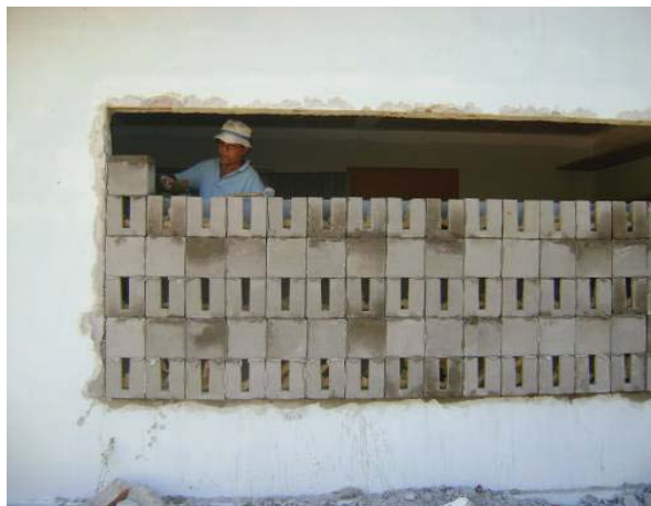
Figura 82. Outra tomada fotográfica da parede de teste montada com bloco tipo 3 com lã de vidro (Cc/lã)
