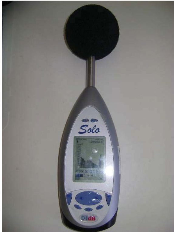
Figura 20. Foto do medidor digital de nível de pressão sonora utilizado no ensaio
