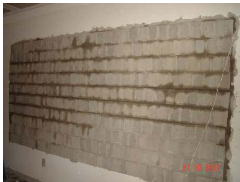
Figura 46. Foto da sala internamente com a parede de testes montada com o bloco tipo 1 (Pfechado)
