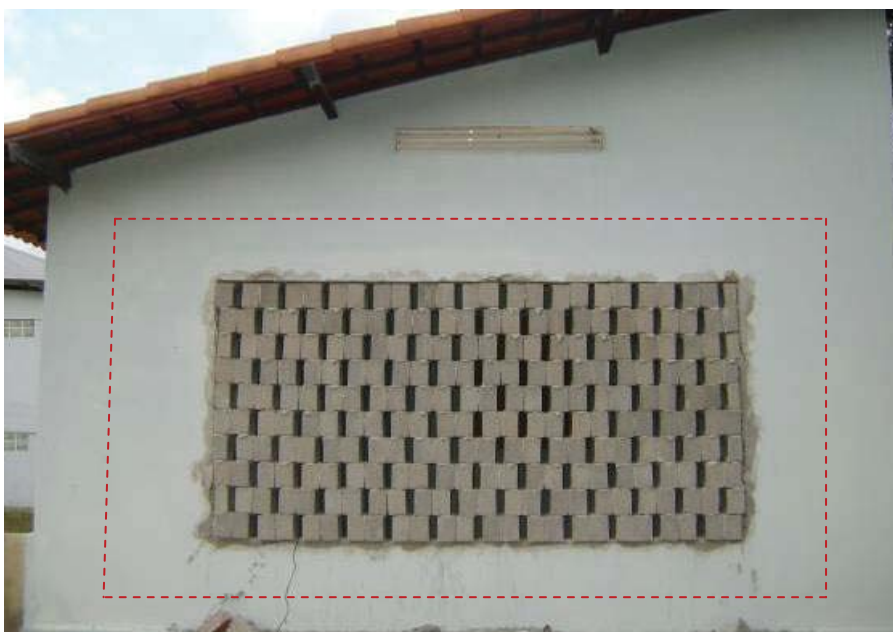
Figura 50. Foto da parede de teste montada com o bloco tipo 1 pequeno (P) espaçados de 5cm e sem lã de vidro (P5s/lã), com indicação da área radiante interna da parede
