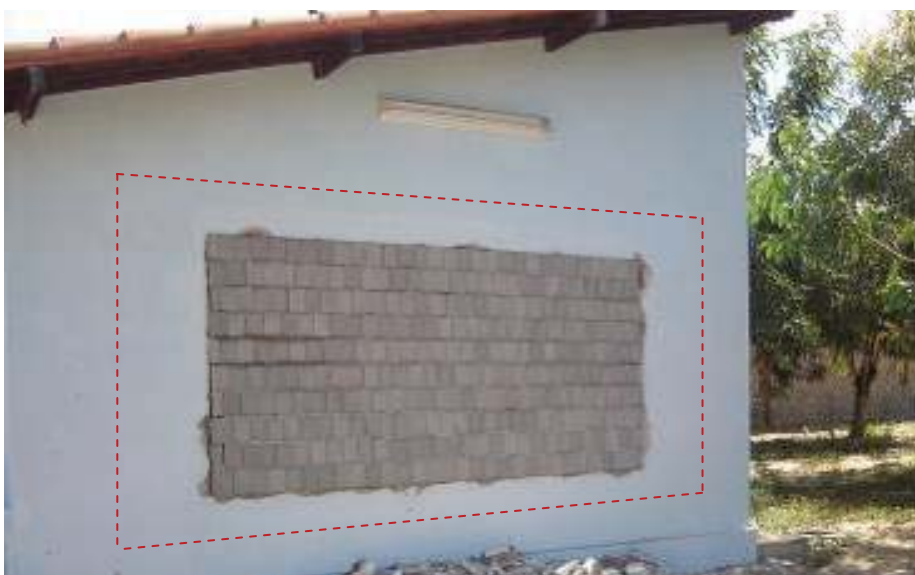
Figura 47. Foto externa da parede de teste montada com o bloco tipo 1 com indicação da área radiante interna da parede
