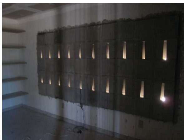
Figura 92. Outra tomada fotográfica interna da parede de teste montada com o bloco tipo 4 aberto sem lã de vidro (CG)
