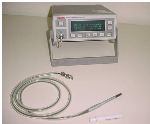
Figura 3.6 Conjunto Câmara – Eletrômetro usado nas dosimetrias de referências.
