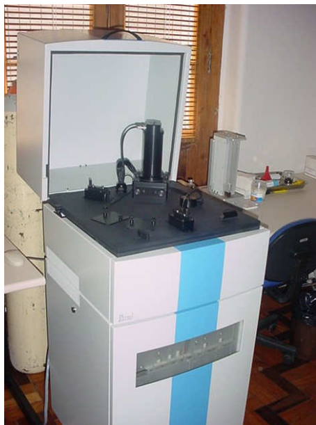
Figura 3.3 Leitora automática PCL 3 utilizada nas leituras dos dosímetros TL.
