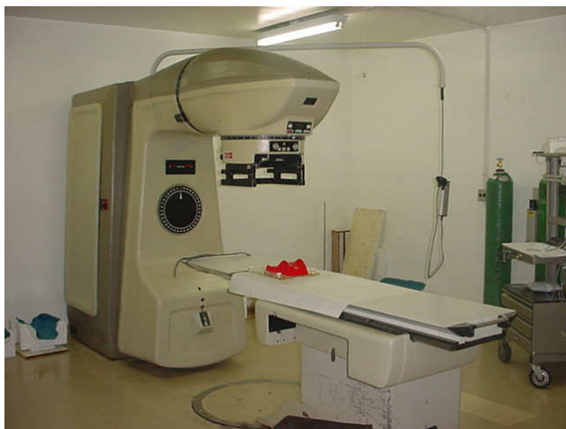
Figura 3.7 Aparelho de ^{60}\text{Co} utilizado na calibração do pó TL.
