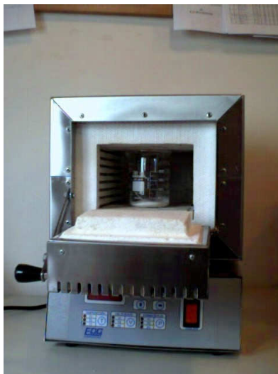
Figura 3.3 Colocação do pó TL no Forno EDG 3000 para tratamento térmico à alta temperatura.
