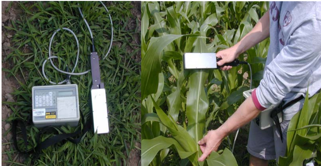
Apêndice 3. Determinação da área foliar de milho a campo com o equipamento Licor 3000A.
