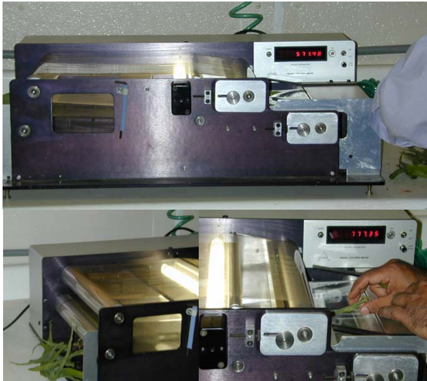
Apêndice 2. Determinação da área foliar de milho em laboratório com o equipamento Licor 3100.
