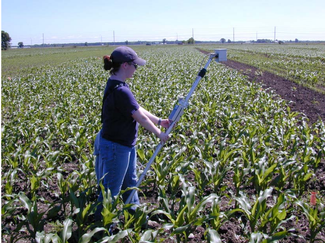
Apêndice 5. Determinação da reflectância do dossel de milho com o radiômetro Crop Scan, modelo MSR87.
