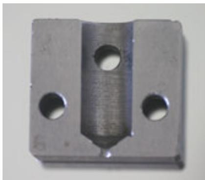
Figura 4 - Cavidade cilíndrica da peça metálica.
