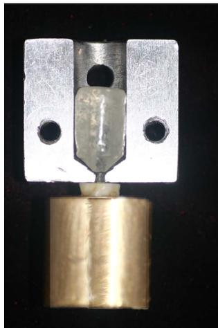
Figura 8 - Porção coronária após a presa final da resina acrílica.
