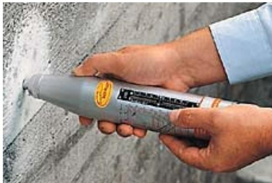
Figura 4.3. Equipamento de esclerometria: Concrete Test Hammer ORIGINAL SCHMIDT.
