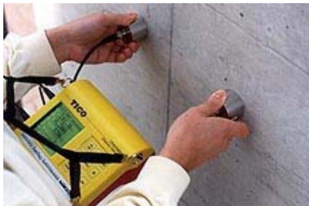
Figura 4.4. Equipamento de Ultrasom: TICO Ultrasonic Instrument.
