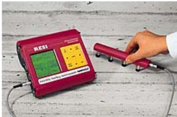
Figura 4.10. Equipamento de medida de resistividade: Resistivity Meter RESI.
