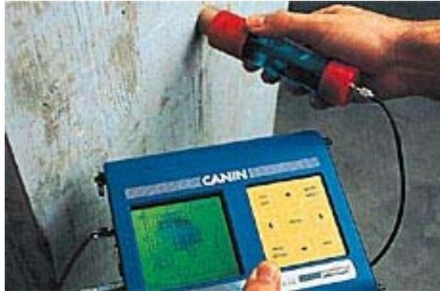
Figura 4.7. Equipamento CANIN Corrosion Analyzing Instrument para medidas de potencial de corrosão.
