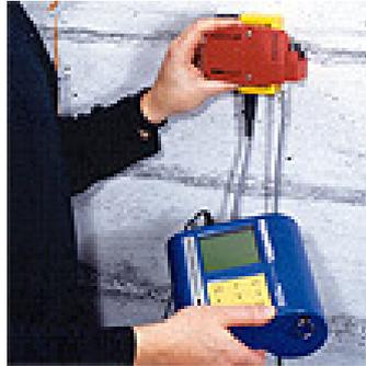
Figura 4.5. Pacômetro: Equipamento Profometer 5.0.
