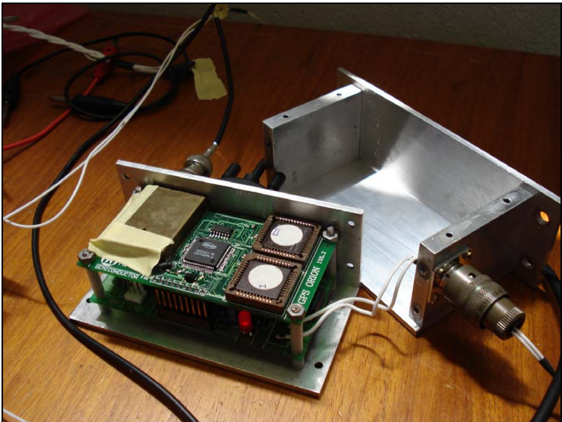
Fotografia 8: Visão interna da caixa de instalação do receptor Fonte: HUMANN, 2008. p. 186
