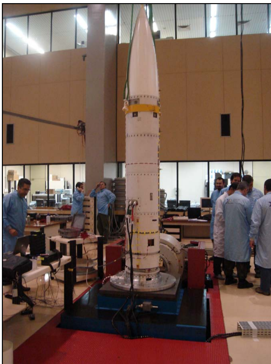
Fotografia 10: Ensaio de vibração com a carga útil no LIT Fonte: Acervo do autor
