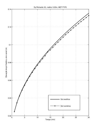
Figura 3.11: Soluções comparadas, analítica e numérica, P1P0, malha:0,05m
