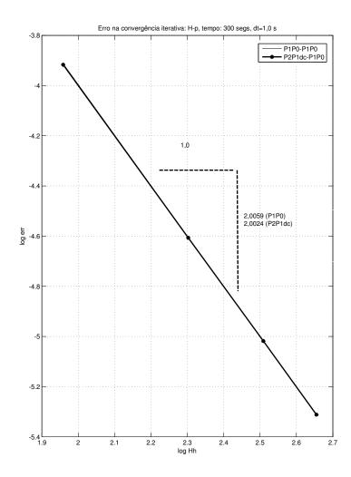
Figura 5.7: Taxa de convergência: erro na carga hidráulica, modelos  $P_1P_0$ - $P_1P_0$  e  $P_2P_{1dc}$ - $P_1P_0$
