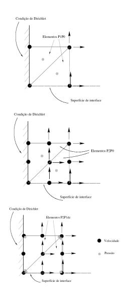
Figura 4.1: Teste de malha: descrição esquemática para elementos P1P0, P2P0 e P2P1dc
