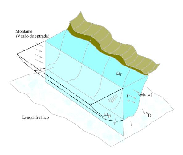
Figura 3.1: Seção longitudinal do sistema acoplado
