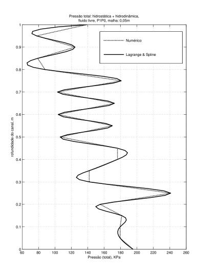
Figura 3.4: Pressão total, perfil não estabilizado, interpolações de Lagrange e Spline (50 pontos), malha:  $0,05\mathrm{m}$
