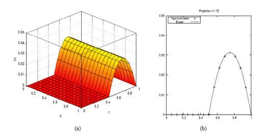
Figura 3.7: Soluções analítica e numérica, escoamento de Pouissouille. Soluções de Beavers e Joseph (exata e experimental), e de Correa e Loula
