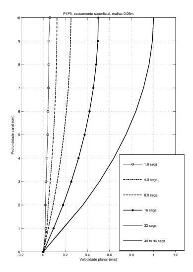
Figura 3.9: Evolução do perfil de velocidade, convergência iterativa, malha: 0,05m
