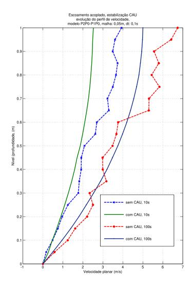
Figura 3.3: Influência da estabilização (CAU) em convecção dominante, perfil da velocidade, escoamento superficialacoplado, malha: 0,05 m,  $\Delta t$ : 0,1 seg, elementos: P2P0-P1P0
