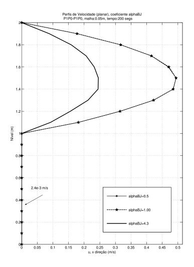
Figura 5.4: Influência do parâmetro de Beavers e Joseph: perfil de velocidade, malha:  $0,05\mathrm{m}$
