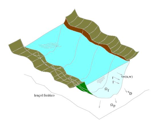
Figura 2.2: Escoamento superficial a sub-superficial não-saturado, visão longitudinal
