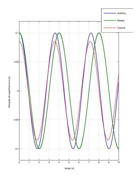
Figura 3.12: Ondulação de baixa amplitude na superfície livre, ponto nodal final, elementos  $P_1P_0$ , malha: 0,5m
