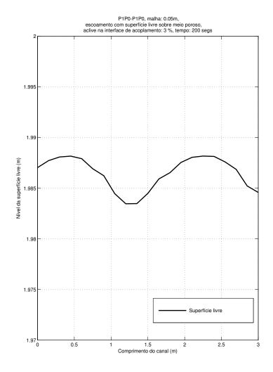
Figura 5.2: Perfil magnificado da superfície livre, canal: 3m x 1m x 1m, malha:  $0.05\mathrm{m}$
