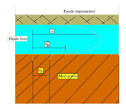
Figura 3.6: Perfil de velocidades, planar, escoamento de Pouissouille: exemplo de Beavers e Joseph
