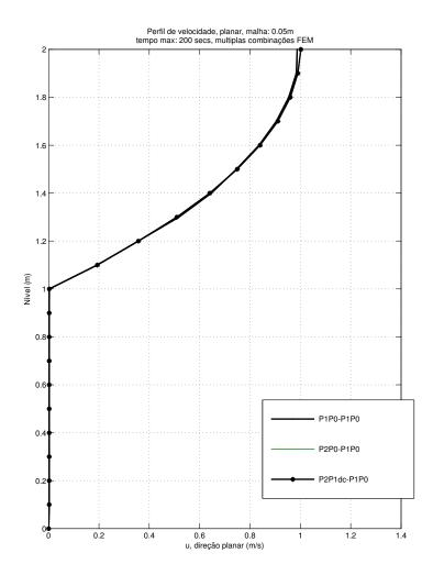
Figura 5.5: Perfis de velocidade planar, fluido livre, elementos  $P_1P_0$ ,  $P_2P_0$ , e  $P_2P_{1dc}$ , malha: 0,05m
