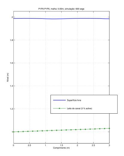
Figura 5.1: Perfis: superfície livre e leito do canal, aclive 3% canal:  $3\text{m} \times 1\text{m} \times 1\text{m}$ , malha:  $0{,}05\text{m}$
