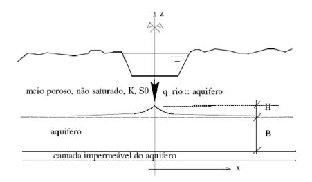
Figura 3.10: Recarga de aqüífero: problema de Gunduz e Aral (numérico), e de Glover (analítico e experimental)
