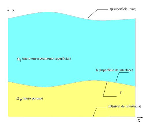
Figura 2.1: Visão esquemática: domínios superficial e sub-superficial acoplados
