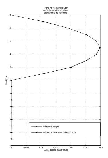
Figura 3.8: Soluções analítica e numérica, problema de Pouissouille: Modelo Proposto e de Beavers e Joseph, seção mediana do canal, malha: 0,05m
