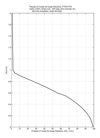
Figura 5.3: Convergência entre pressão total no fluido livre e função de carga hidráulica, seção final, malha: 0.05m
