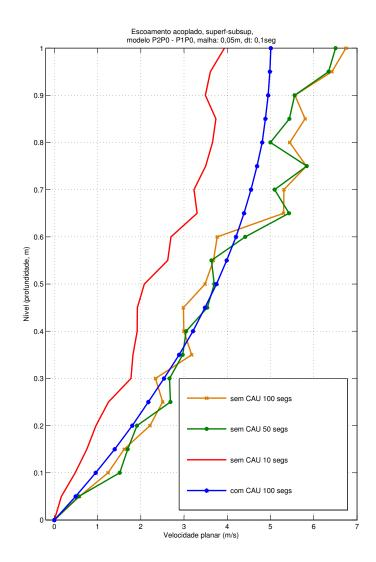
Figura 3.2: Evolução do perfil da velocidade do fluido superficial, escoamento acoplado, impacto do CAU, malha: 0,05 m,  $\Delta t$ : 0,1 seg, elementos: P2P0-P1P0
