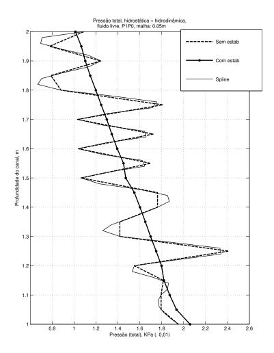
Figura 3.5: Perfis comparados da pressão total, com e sem estabilização, interpolação de Lagrange (40 pontos), malha:  $0.05 \mathrm{m}$
