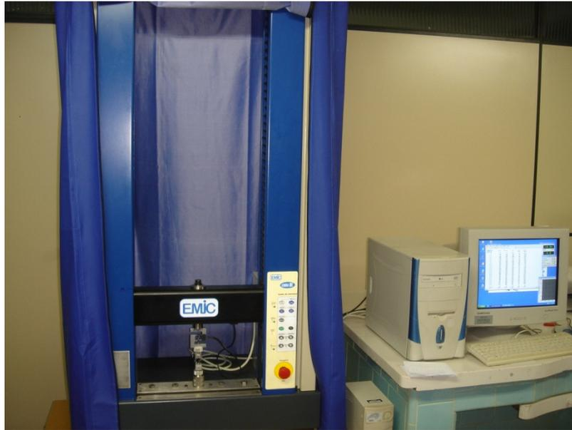
Figura 18: Máquina de Ensaio EMIC DL 500, com o software Tesc 3.01.
