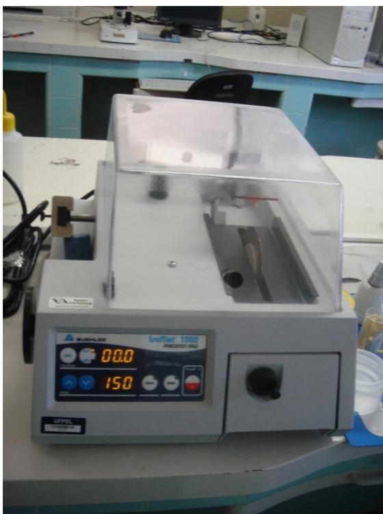
Figura 13: Máquina de cortes de precisão ISOMET 1000.
