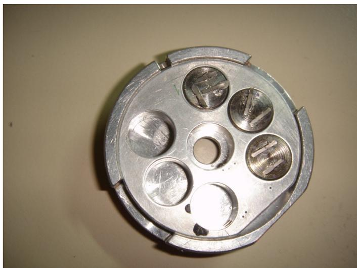
Figura 19: Palitos depois de metalizados e colocados nos stubs.
