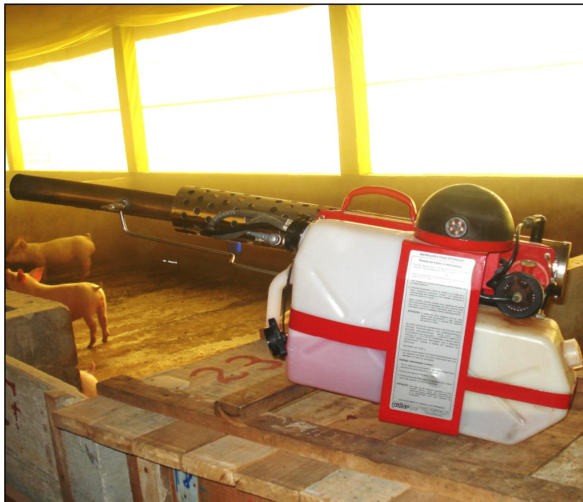
Figura 1. Aparelho termonebulizador movido a gasolina durante a aplicação de desinfetante em galpão de terminação.
