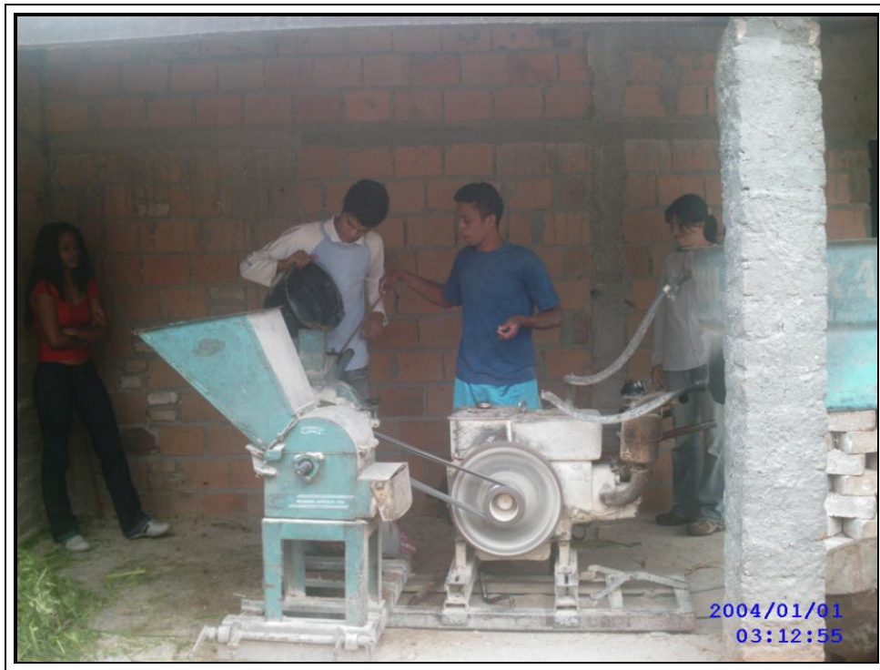
Ilustração 5. Motor e máquina de forrageira: preparando a ração para a criação.
