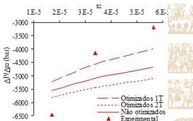
Figura 5 – Variação da pressão de bolha com a fração molar de tetracontano ( x_2 ) versus x_2 para temperatura de 363K.
