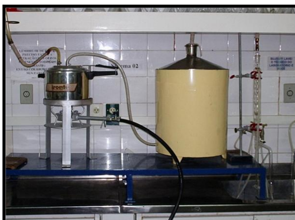
FIGURA 6 - Aparelho de destilação com arraste de vapor d'água
