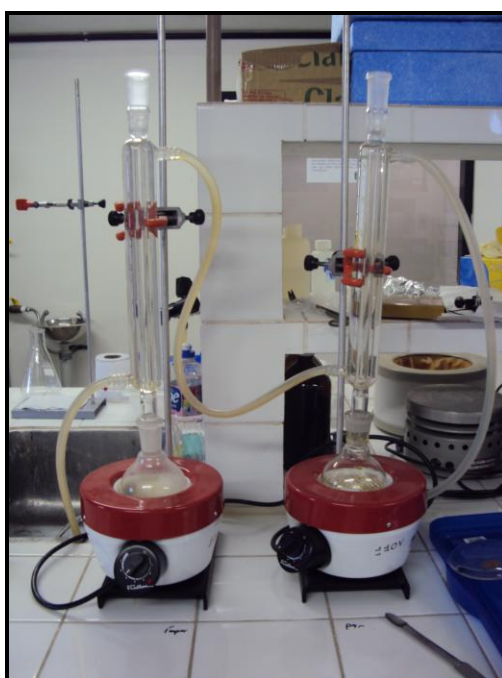
Figura 3.5: Montagem experimental para determinação do COT
