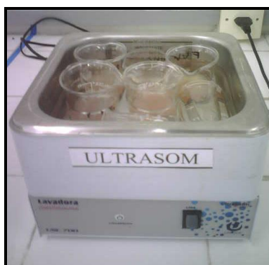
Figura 3.6: Ultra-som utilizado na extração dos HPA
