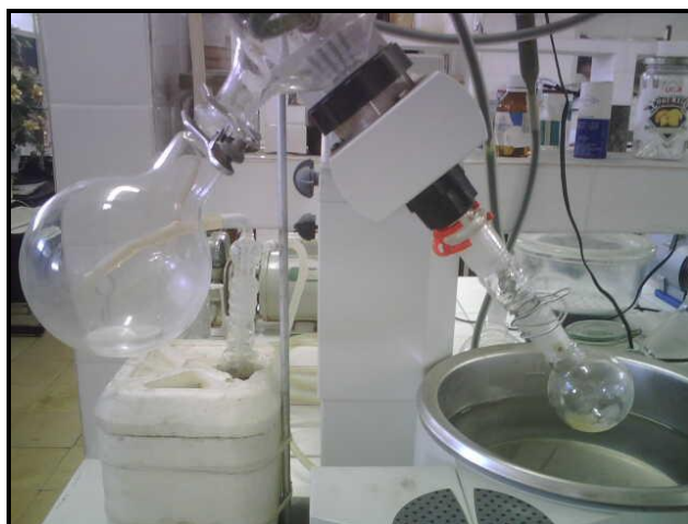
Figura 3.7: Evaporador rotativo utilizado na extração dos HPA
