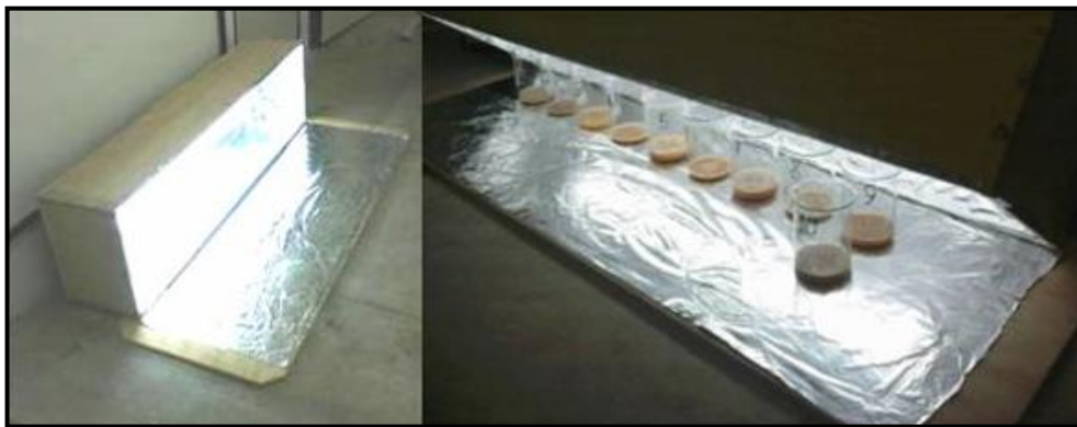
Figura 3.2: Montagem experimental para geração de UV (luz fluorescente)
