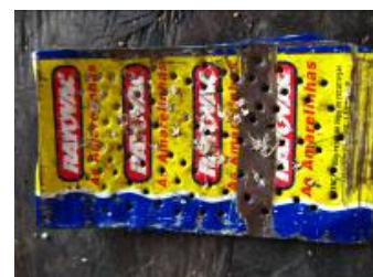
Figura 36. Ralador fabricado com lâminas de pilhas.
