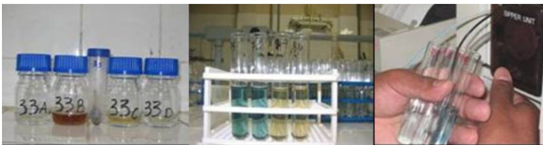
Figura 8. Extratos obtidos após a extração, colorimetria e determinação das frações do Fósforo.
