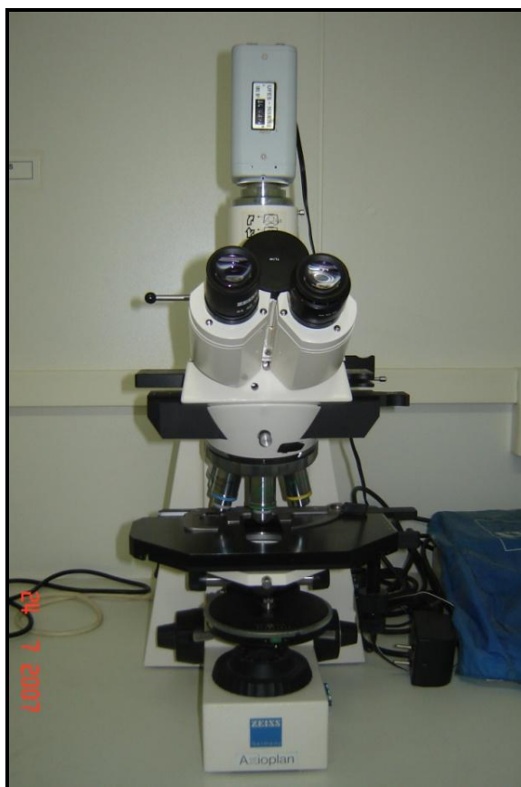
Figura 12. Microscópio de Epifluorescência utilizado para identificação de protozoários (ZEISS TM Axioplan HBO 50, com filtros de 450-490nm de excitação e 510nm de supressão).
