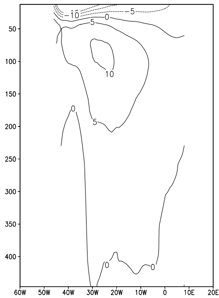
Figura 5.57: Perfil equatorial da média da componente zonal das correntes, para o bimestre março-abril, da simulação ASSIM II-a. Unidade: cm/s.
