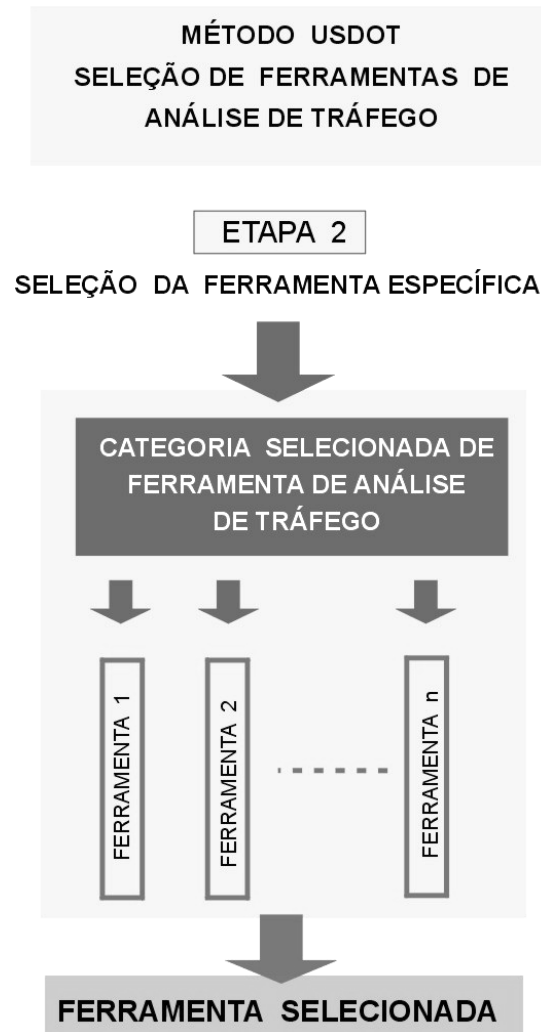
Figura 6.2: Método USDOT Etapa 2 – Escolha da Ferramenta Específica (USDOT, 2004)
