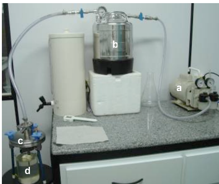
Figura 10: Recipiente de pressão para dispensação (Millipore), constituído por uma bomba à vácuo (a), recipiente onde o volume de água é adicionado (b) e local para inserção da membrana (c). Também é possível visualizar a amostra após filtração (d).
