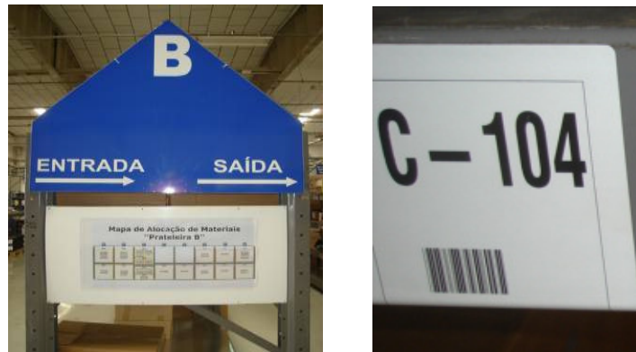
Figura 6.9 - Identificação das fileiras de racks /FIFO e etiqueta de endereçamento da alocação
