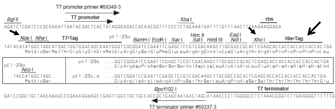
FIGURA 7 – Representação esquemática da seqüência do sítio de clonagem múltipla do vetor pET23a(+). As setas cheias indicam os sítios de clivagem para as enzimas Nde I e Xho I. A seta vazada indica o His-Tag. Modificado de (Novagen, 2006).
