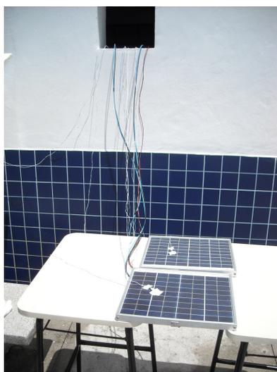
Figura 4.4 – Painéis fotovoltaicos expostos à radiação solar
