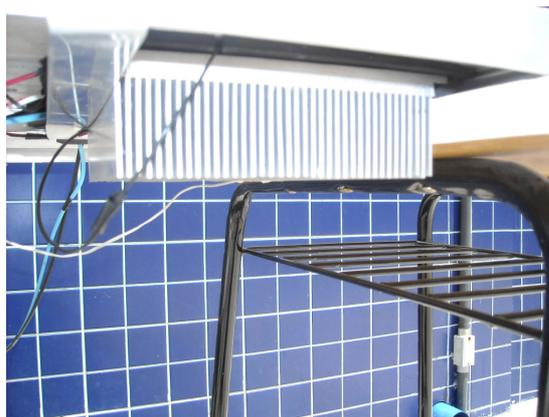
Figura 4.5 – Dissipador de calor e módulo termoeletrico ligados ao painel fotovoltaico
