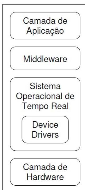
**Figura 3.3. Camadas de um receptor digital (Piccioni, 2005)**
