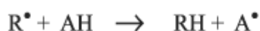
Figura 2.5: Mecanismo de ação para os antioxidantes primários \text{ROO}^\bullet - Radicais livres; \text{AH} - Antioxidante com um átomo de hidrogênio ativo; \text{A}^\bullet - Radical inerte.
