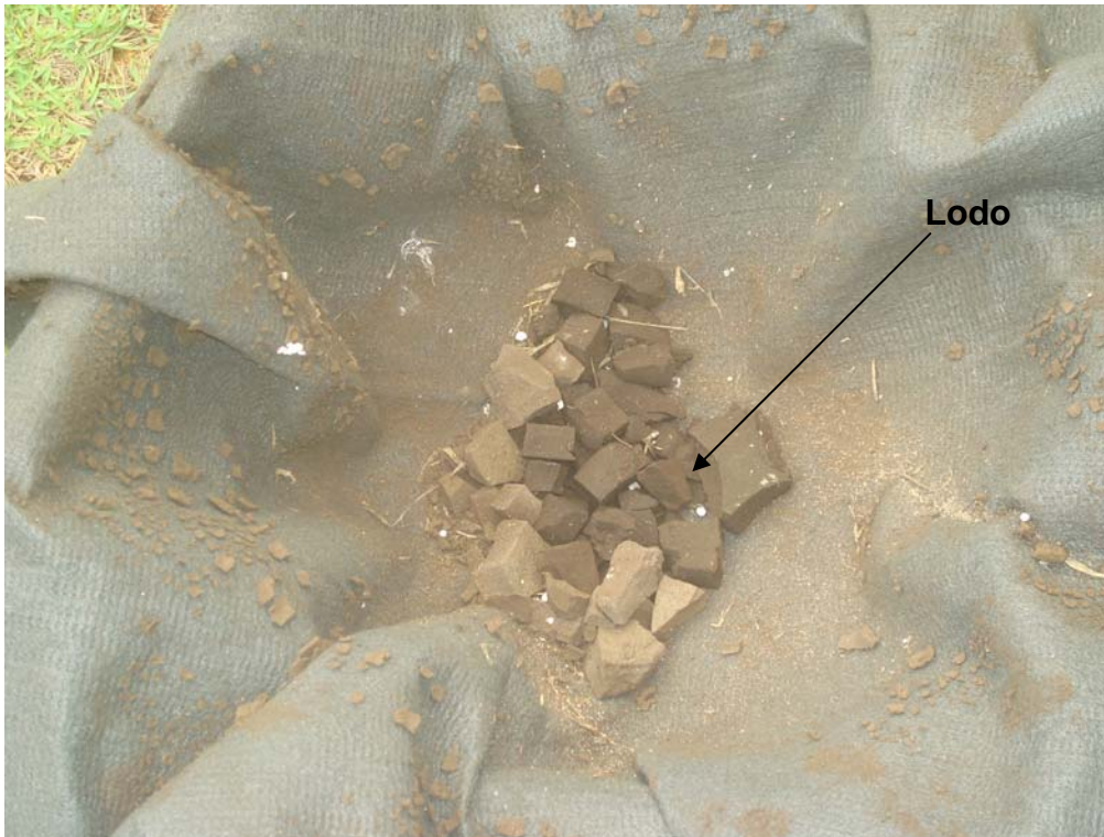
Figura 4.3- Foto do material em processo de secagem- Lodo proveniente de tratamento que utiliza Cloreto de Polialumínio como coagulante químico
