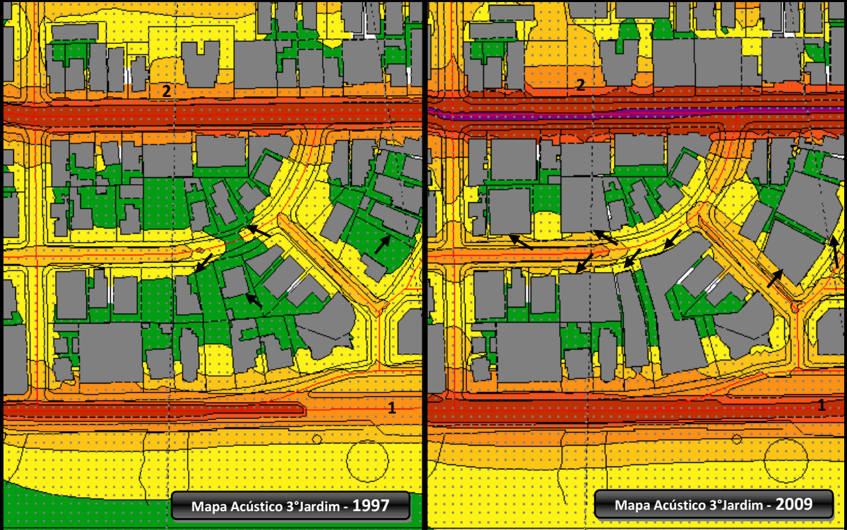
Figura 5.25 e 5.26 – Seção Vertical 1 – As ilhas de sombra em 1997 favoreciam as residências unifamiliares e multifamiliares de gabarito baixo existentes que se situavam em seus interiores. Em 2009 estas ilhas foram praticamente suprimidas pela presença de pavimentos destinados as garagens das novas edificações verticais de gabarito alto, como ilustram as setas em preto. Fonte: elaborado pela autora.
