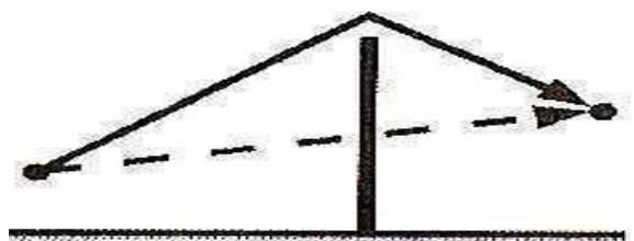
Figura 2.22 – Barreira acústica entre a fonte e o receptor. Fonte: ANDERSON e KURZE, 1992.
