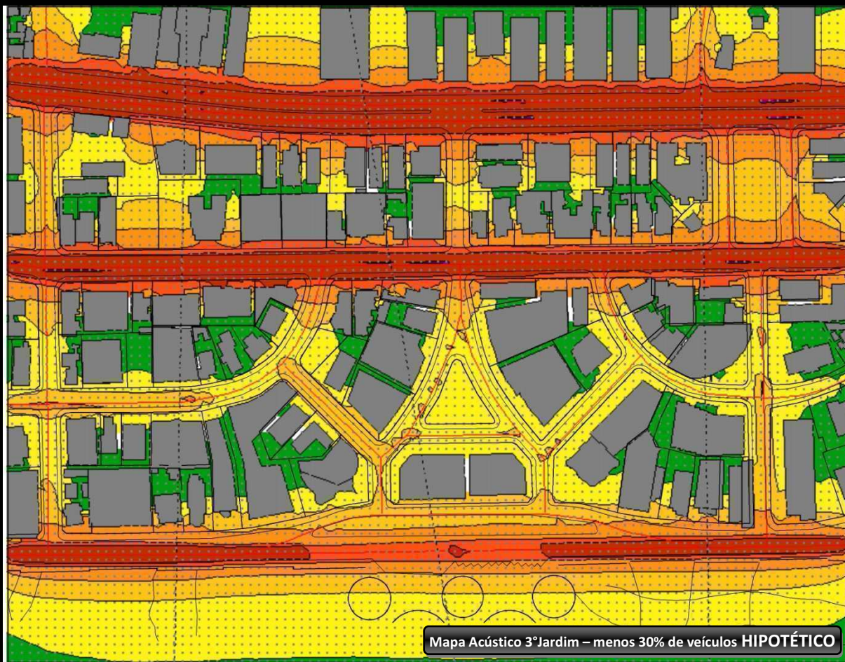
Figura 5.49 – Planta Baixa – Mapa acústico simulando uma situação onde seja implantado rodízio de veículos, com uma redução de 30% do valor total do fluxo de veículos atualmente encontrado no 3º Jardim de Boa Viagem (2009). Fonte: elaborado pela autora.
