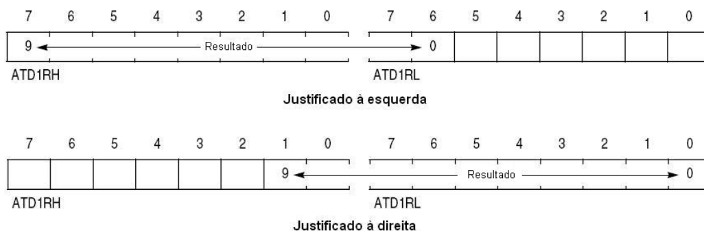
Figura 4.5: Registradores de resultados ( ATD1RH e ATD1RL ).
