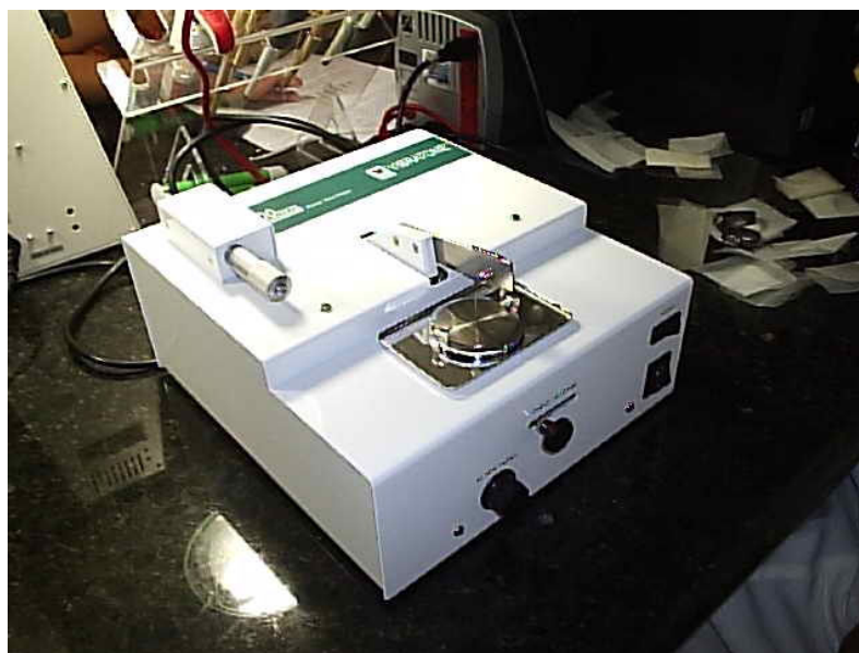
Figura 2 – Tissue chopper utilizado na fragmentação do tecido ovariano.
