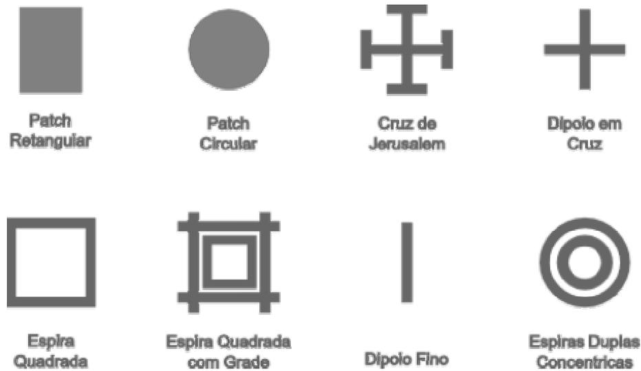
FIGURA 2.1 – Formas dos elementos *patches* condutores.
