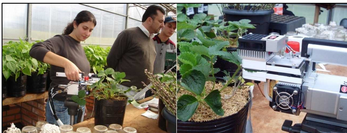
Figura 03 – Avaliação das trocas gasosas das plantas de morango através do analisador portátil de CO 2 a infravermelho (IRGA). UTFPR, 2009.
