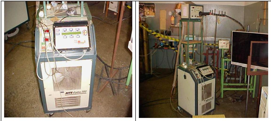
Figura 3.1: Ilustração da Fonte MTE Digitec 300 e do Alimentador IMC STA-120.
