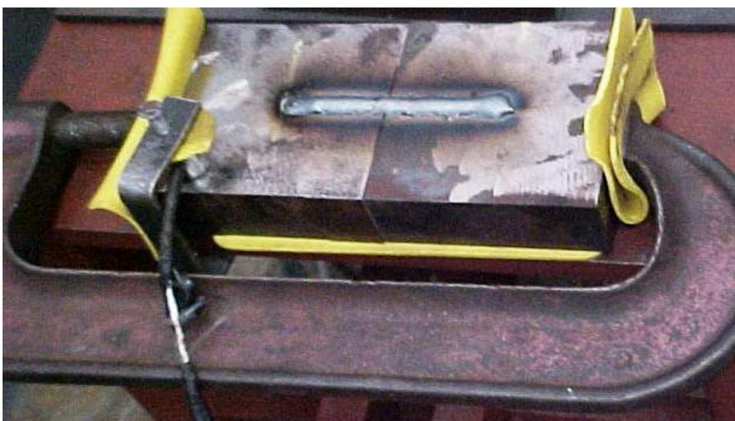
Figura 3.19: Detalhe do isolamento entre o sensor e o corpo de prova.
