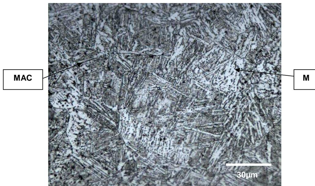
Figura 5.29: Micrografia da ZAC do teste 8 junta soldada com Eletrodo E11018G. Nital 2% Microscopia óptica (1000x).
