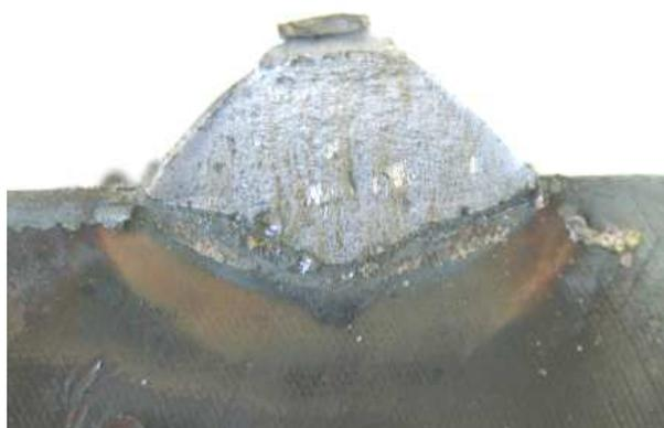
Figura 5.24: Ilustração do cordão de solda do teste 9, soldado com ER e gás de purga.
