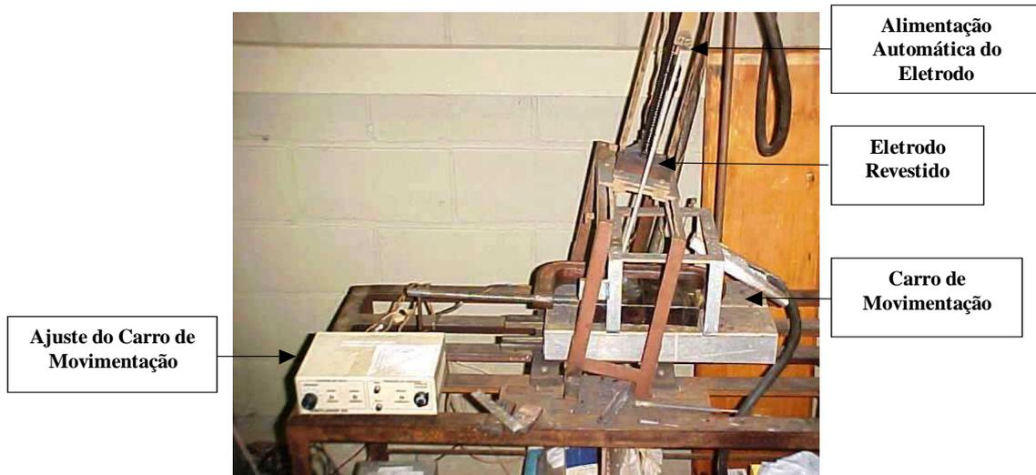
Figura 3.4: Montagem do Teste G-BOP para o Sistema de Alimentação de Eletrodo Revestido.
