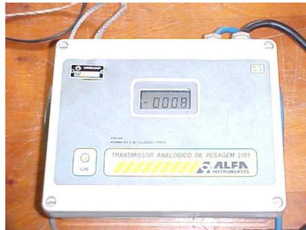
Figura 3.27: Transmissor Analógico de pesagem.
