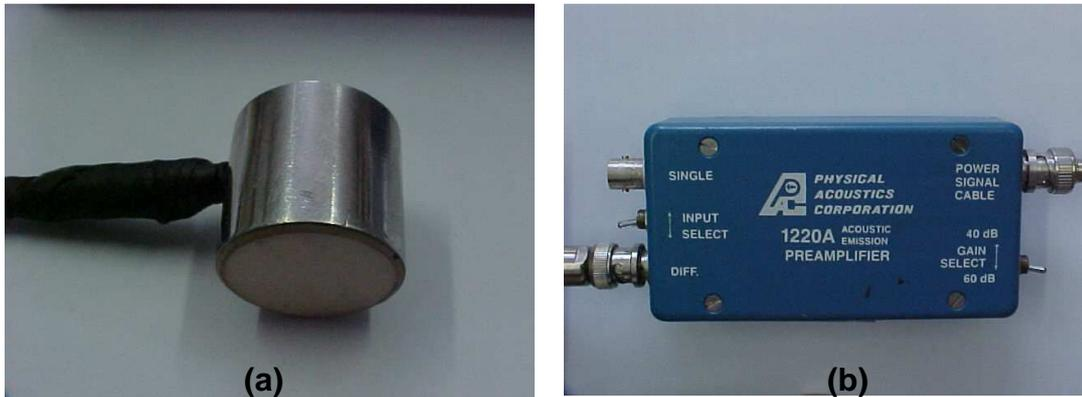
Figura 3.5. (a) Sensor de Emissão Acústica, (b) Amplificador e Filtro.
