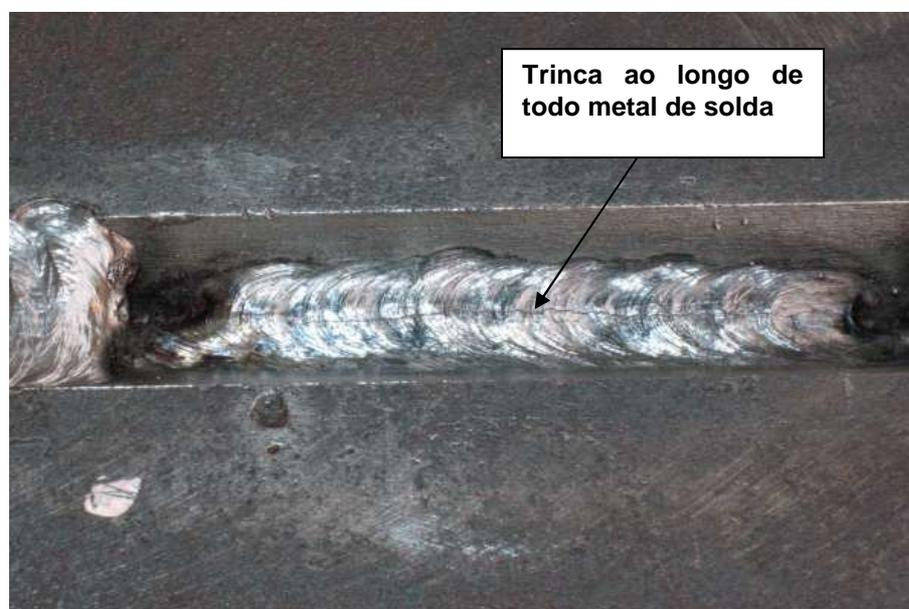
Figura 6.8: Vista Superior do Cordão de Solda trincado para Soldagem com Eletrodo Revestido e Corpo de Prova Limpo.
