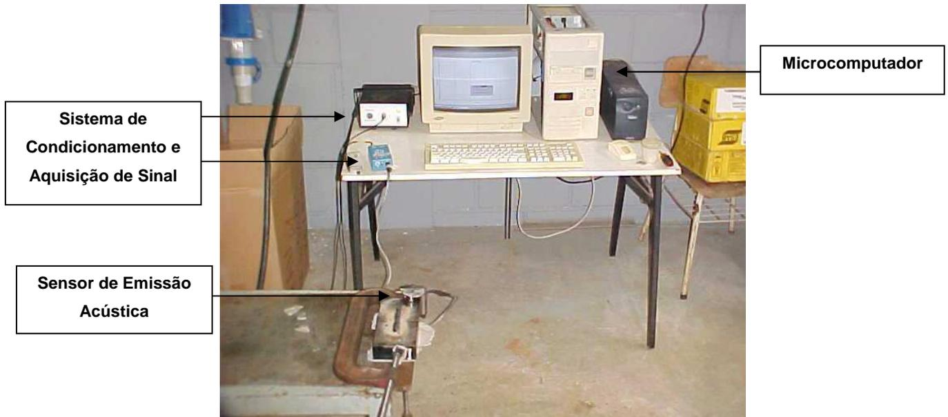
Figura 3.8: Montagem Experimental do Sistema de Emissão Acústica.
