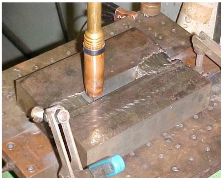
Figura 3.23: Ilustração dos Corpos de Prova para Ensaio Tekken com as soldas de ancoramento.
