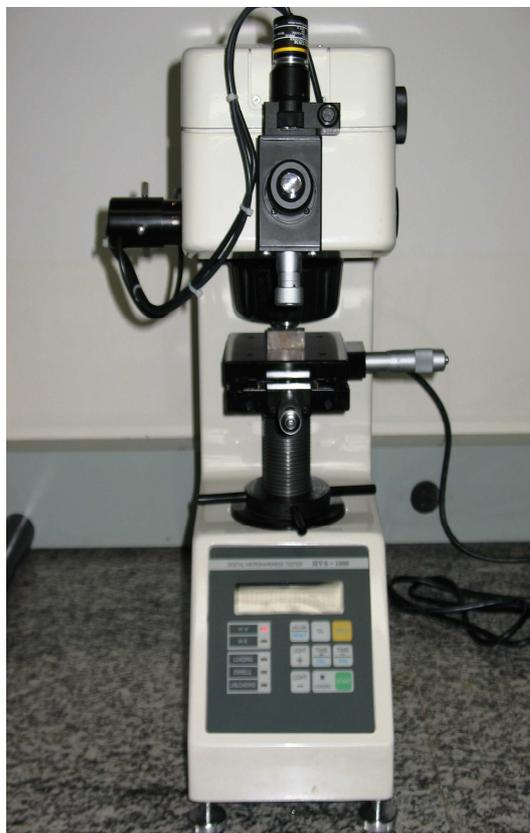
Figura 3.29: Microdurômetro de bancada utilizado na medição de Dureza Vickers.
