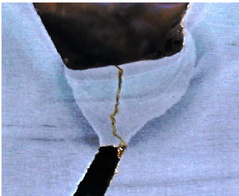
Figura 6.18: Vista transversal do corpo de prova limpo soldado com ER ressecado (teste 8).
