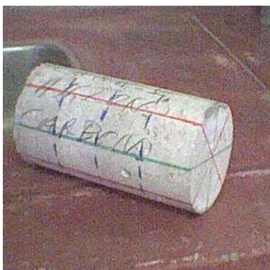
Figura 4.18 - Corpo-de-prova, marcados as posições a serem seccionadas transversalmente para posterior medida de profundidade de carbonatação.
