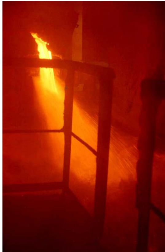
Figura 2.2 – Resfriamento brusco da escória de alto-forno, por jatos d’água, na Companhia Siderúrgica de Tubarão.
