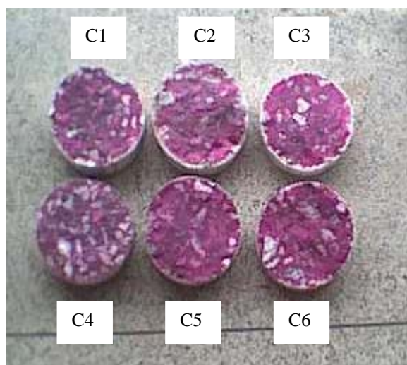
Figura 5.41 - Corpos-de-prova carbonatados dos concretos C1, C2, C3, C4, C5 e C6 para a idade de 63 dias, após a moldagem, antes de serem colocados na câmara de carbonatação.
