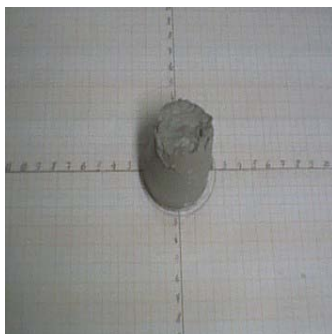
Figura 5.25 - Ensaio de referência, utilizando o método do mini- slump , para pasta, no traço 1:1 (cimento : escória moída), sem aditivo, para o tempo de 0 minutos
