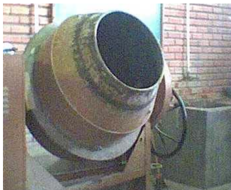
Figura 4.12 - Betoneira de eixo inclinado e tambor giratório basculante com capacidade de mistura de 320 litros.
