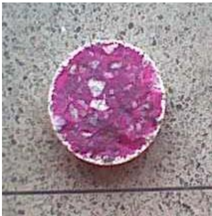
Figura 4.19 – Corpo-de-prova seccionado mostrando o interior do corpo-de-prova em vermelho carmim e uma faixa externa carbonatada.
