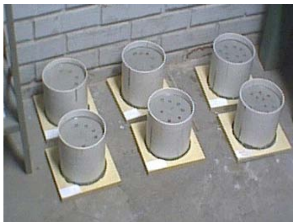
Figura 4.11 – Amostras de argamassas com ADT2, ADT3 e ADT4 para o ensaio de início de pega, através da resistência à penetração com utilização de penetrômetro.
