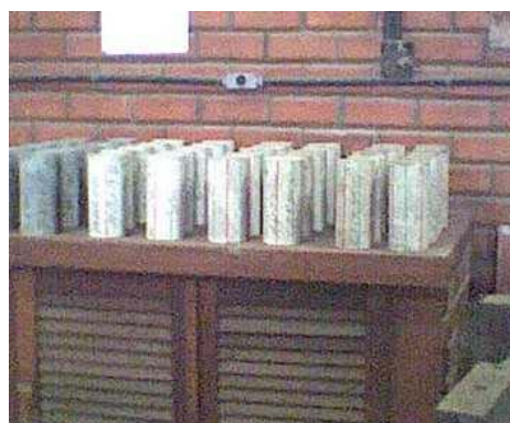
Figura 4.17 – Corpos-de-prova em ambiente de laboratório, para posterior colocação na câmara de carbonatação.
