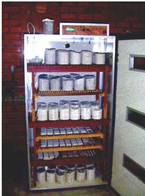
Figura 4.20 – Câmara de carbonatação com os corpos-de-prova cilíndricos.
