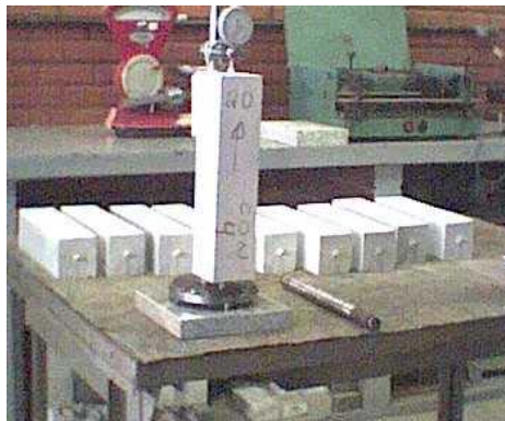
Figura 4.16 – Corpos-de-prova para medidas de retração, utilizando micrômetro.
