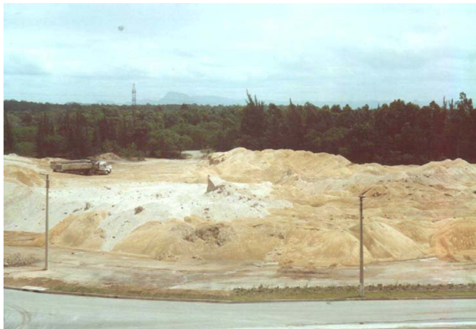
Figura 2.3 – Escória granulada de alto-forno nos pátios da Companhia Siderúrgica de Tubarão.
