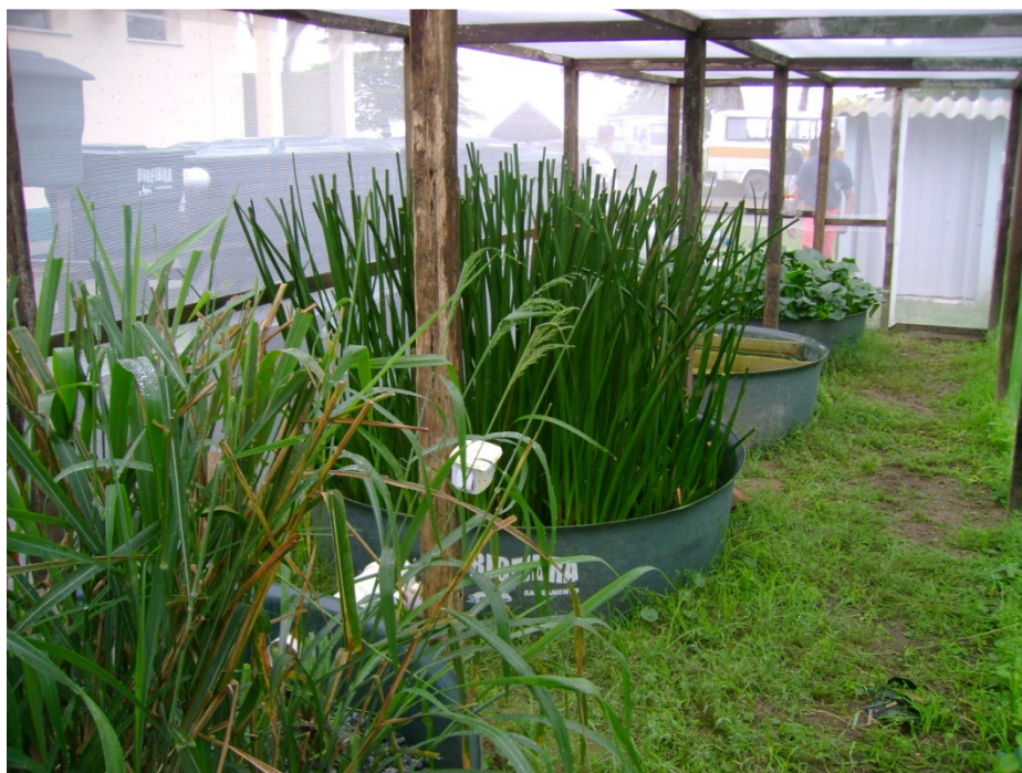
Figura 72: Tanques do sistema alagado, vegetados por macrófitas ( Eichhornia crassipes , Schoenoplectus sp. , Panicum cf. racemosum ) e alga.
