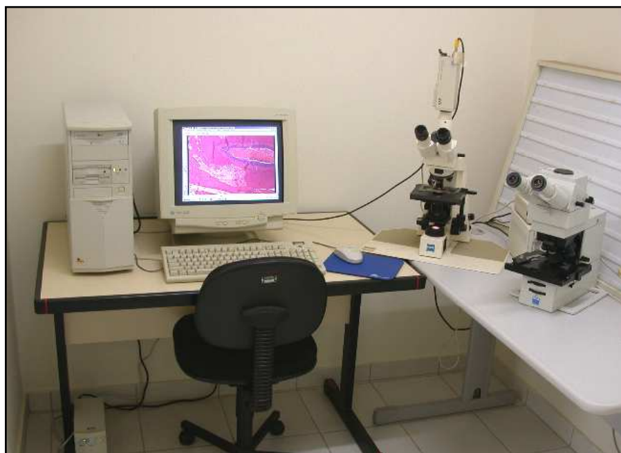
FIG.01 - Equipamento utilizado na captação das imagens histológicas. Câmera digital (JVC TK-1270 Color Vídeo Câmera) acoplada ao microscópio Carl Zeiss (Axiolab) e conectada ao computador.
