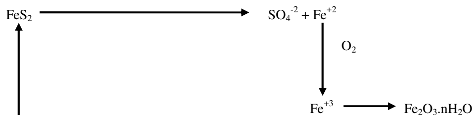
Figura 3.7. Processo oxidativo da pirita (Adaptado de STUMM e MORGAN, 1996).
