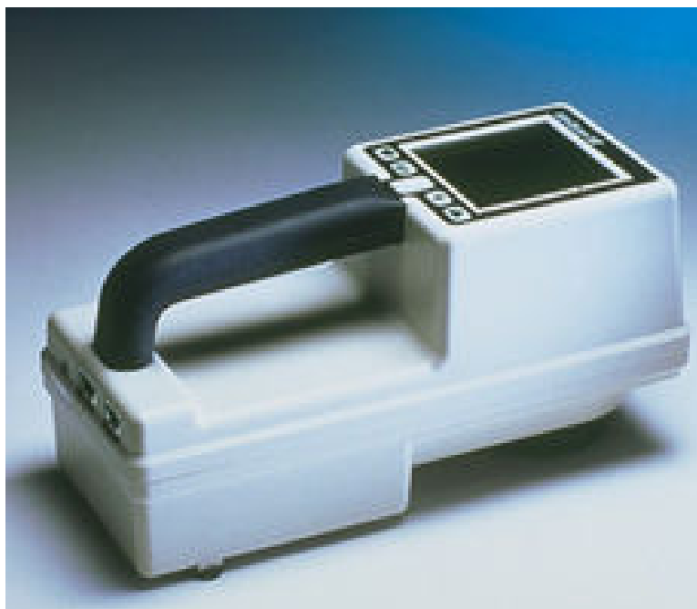
FIGURA 12 - COLORÍMETRO ELETRÔNICO UTILIZADO PARA MEDIR A COLORAÇÃO DA CASCA DE ONZE CULTIVARES DE PÊSSEGO, PRODUZIDOS NA LAPA-PR DURANTE A SAFRA 2008/2009.
