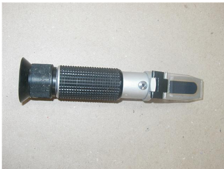
FIGURA 14 – REFRAATÔMETRO MANUAL UTILIZADO PARA AVALIAÇÃO DO TEOR DE SÓLIDOS SOLÚVEIS DE ONZE CULTIVARES DE PÊSSEGO, PRODUZIDOS NA LAPA-PR DURANTE A SAFRA 2008/2009.
