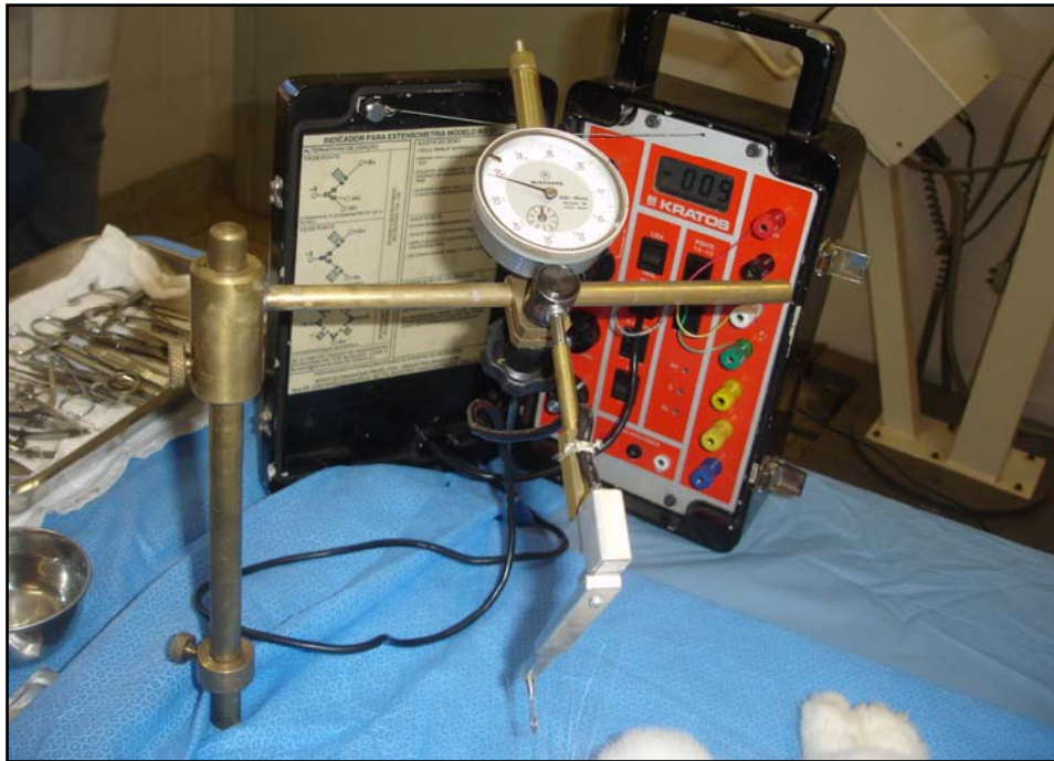
Figura 5: Aparelho de medidas ligado à ponte de extensiometria.
