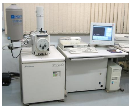
2. Microscópio eletrônico de varredura SM-300 (TOPCON – Tokyo, Japan) do Instituto de Química de Araraquara - UNESP.
