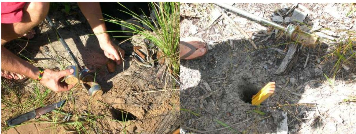
**Figura 47.** Ferramenta utilizada para retirada de amostras de solo
