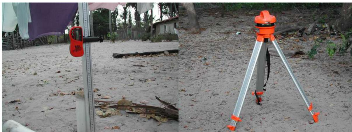
**Figura 64.** Nível digital utilizado no levantamento topográfico. Fotos tiradas durante trabalhos de campo.
