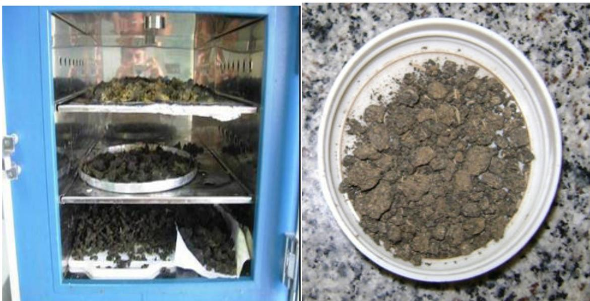
Figura 3 - Secagem do resíduo em estufa com circulação de ar, a 55°C. Resíduo após processos de trituração, sacarificação, fermentação alcoólica, destilação e secagem.
