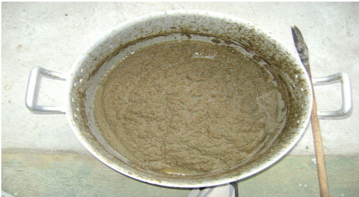
Figura 2 – Resíduo úmido de batata-doce após processos de trituração, sacarificação, fermentação alcoólica e destilação
