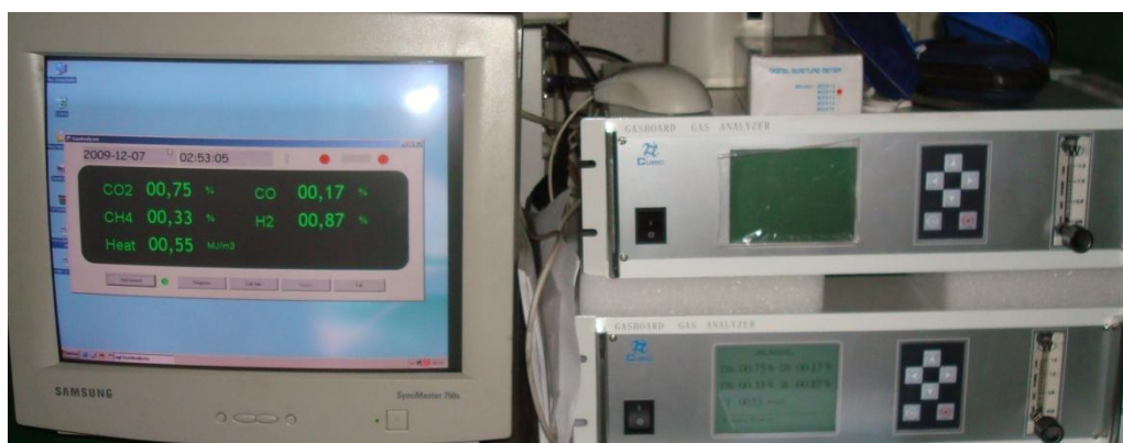
Figura 3.2 - Sistema de monitoramento da composição química do gás de síntese.
