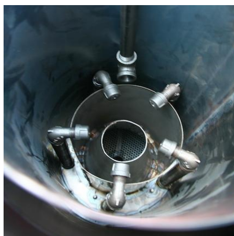
Figura 3.3 - Detalhes das zonas de combustão e redução.
