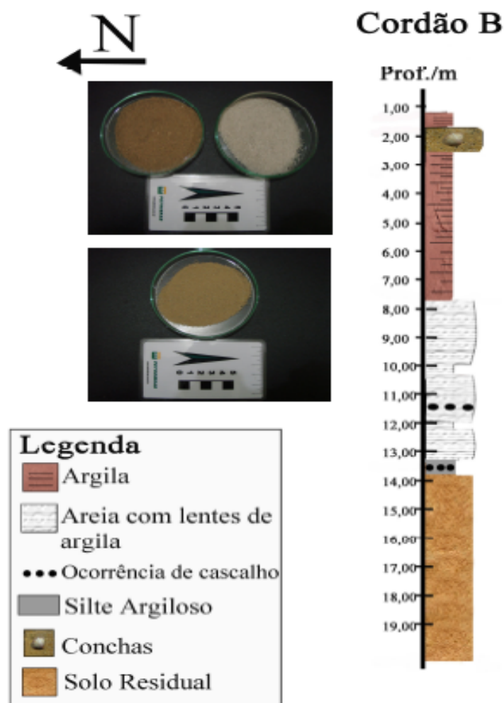
Figura 34 – Perfil litológico do cordão B, com fotos das amostras a 1,45-1,90, 2,45-3,00 e 7 metros de profundidade.
