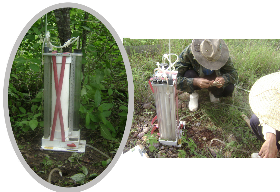
Figura 11 – Equipamento de medição de condutividade hidráulica saturada (Amoozometer).
