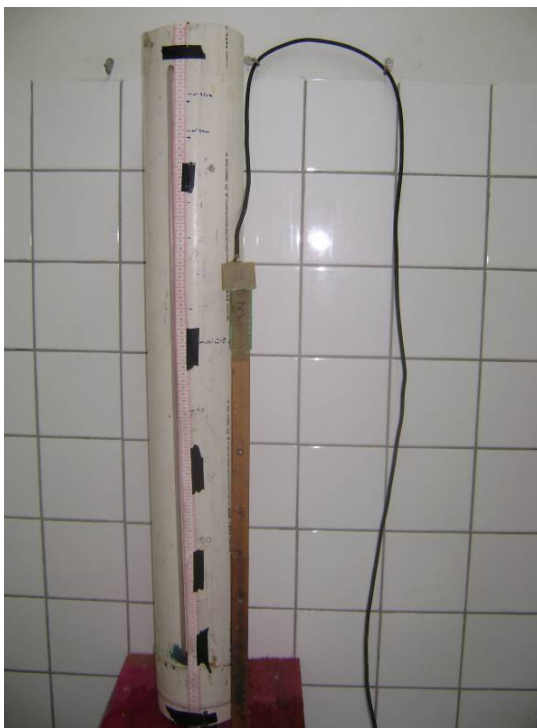
Figura 17 – Equipamento empregado para calibração do sensor de nível de água no LEMA.
