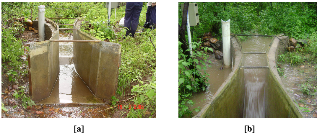
Figura 15 – Detalhe da calha Parshall instalada em campo (maio 2008), [a] visão geral, [b] em funcionamento.
