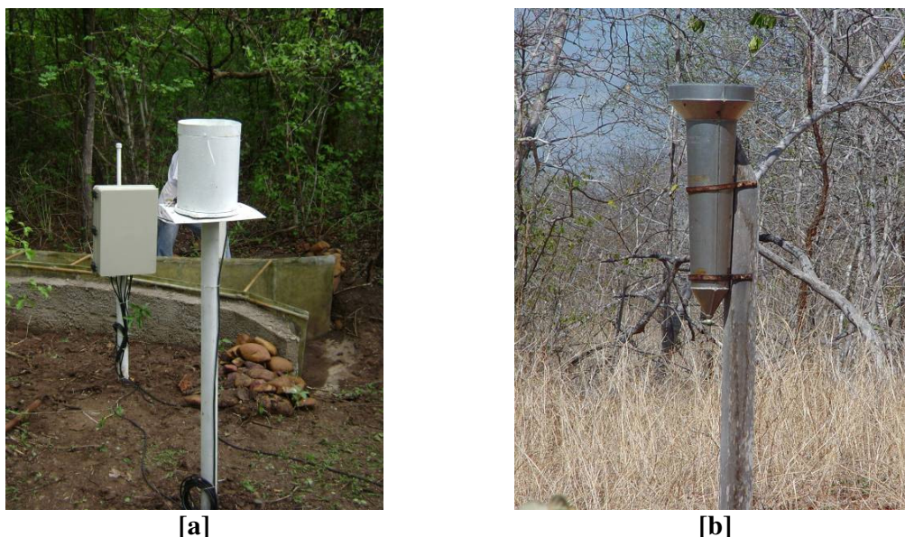
Figura 13 – Detalhe do Pluviógrafo de báscula [a] e Pluviômetros do tipo Ville de Paris [b].
