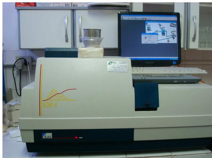
Figura 5 - Foto do analisador de partículas a laser, modelo Cilas 1064
