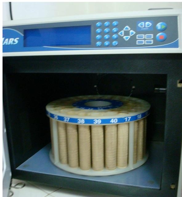
Figura 6 - Foto do forno de microondas MARS CEM.
