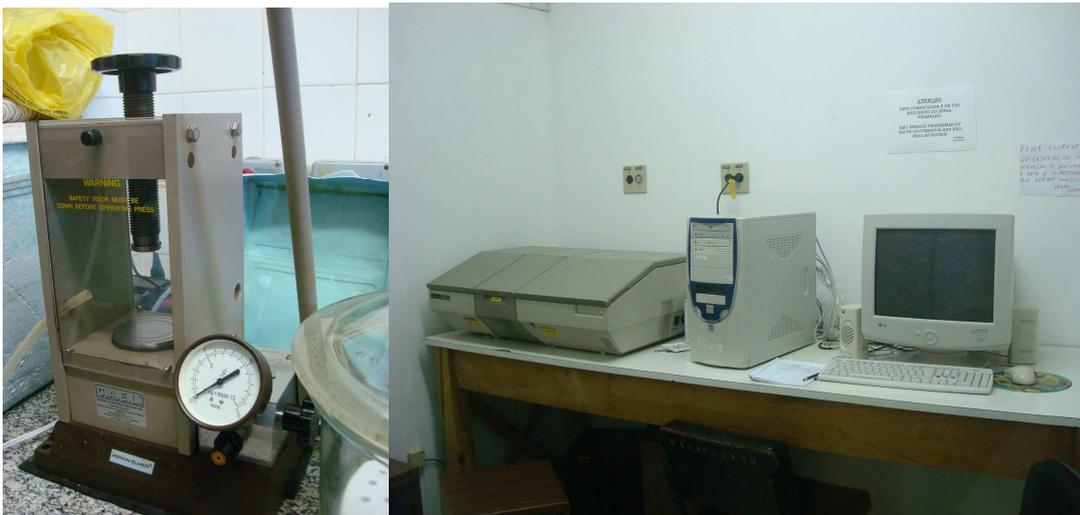
Figura 4 - Foto da prensa (esquerda) e do espectrômetro infravermelho modelo SPECTRUM 1000 CSI-L118-M100
