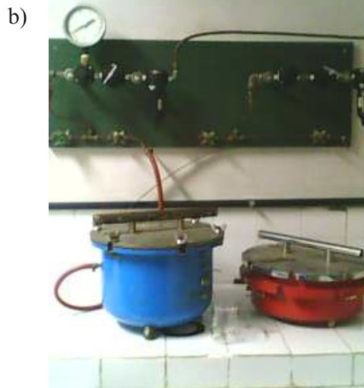
Figura 04 – a) Coleta de amostras indeformada em campo e b) Câmaras de pressão de Richards.
