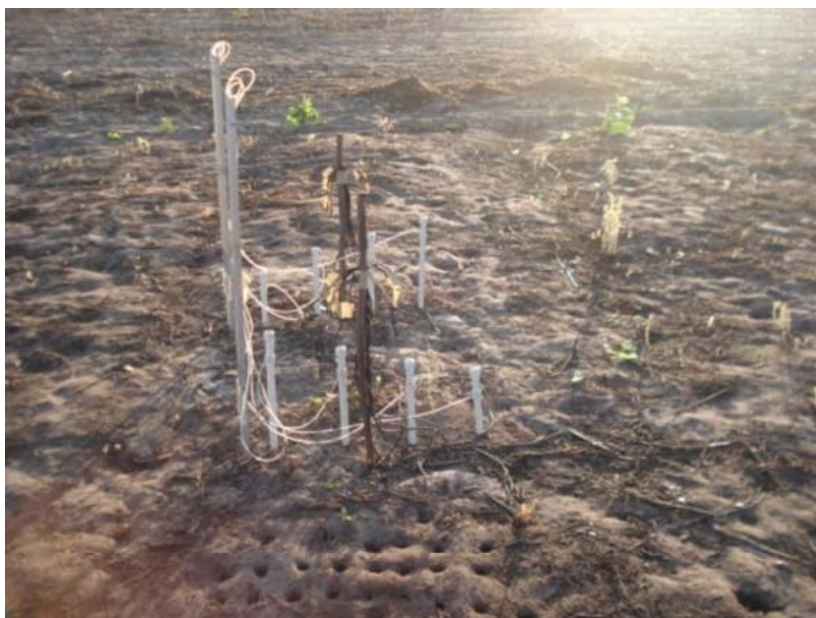
Figura 05 – Parcela experimental em campo para determinação do K(\theta) .
