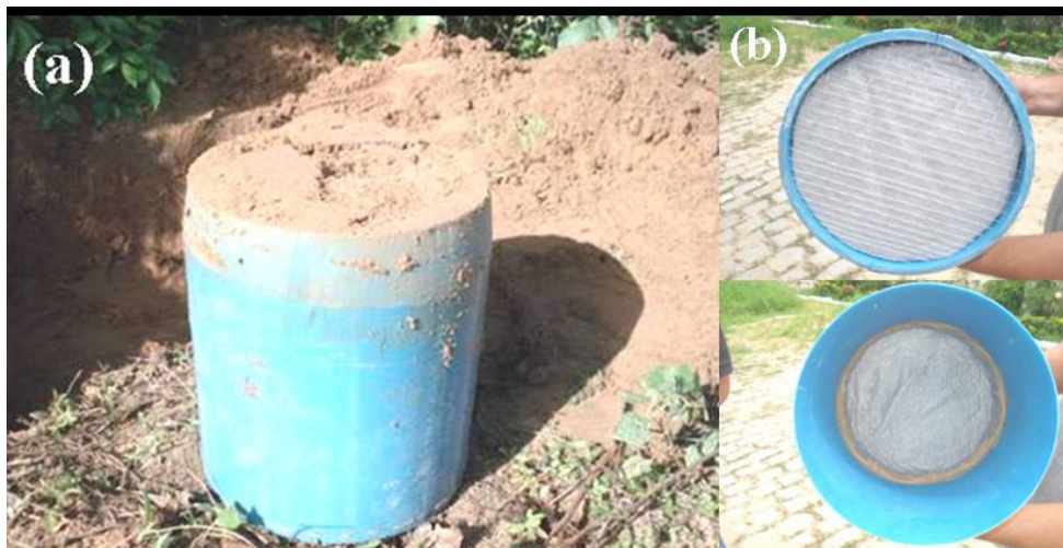
Figura 5 - Segmento de PVC contendo amostra de solo indeformada (a) e detalhe, interno e externo, de sua parte inferior (b).
