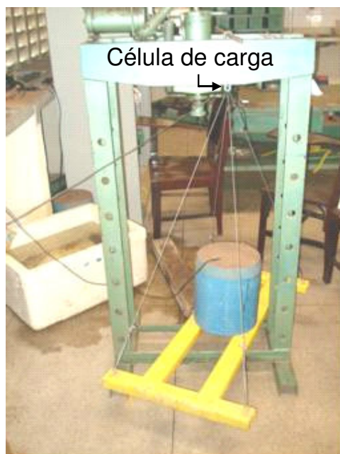
Figura 6 - Estrutura utilizada para a calibração com os principais componentes: PVC contendo solo e com o sensor capacitivo FDR inserido; balança e célula de carga.
