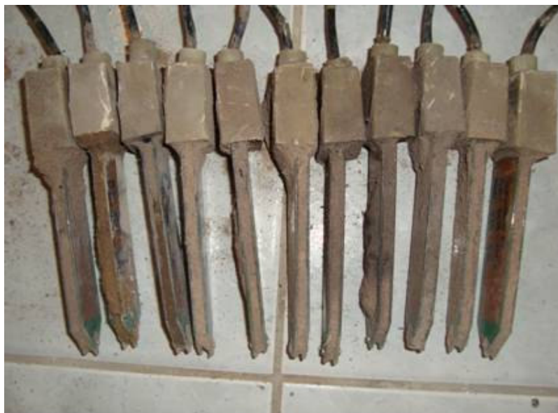
Figura 26 – Sensores capacitivos FDR retirados do solo.
