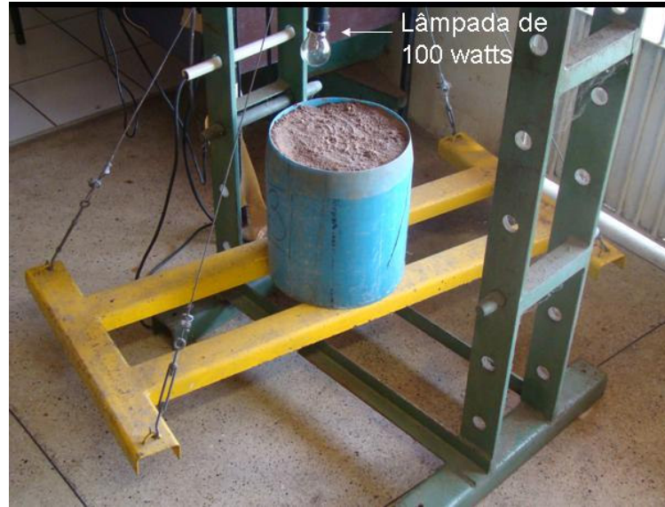
Figura 8 – Balança de calibração com a lâmpada implementada.
