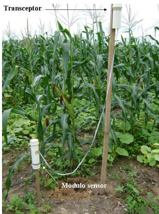
Figura 37 – Elevação do transceptor acima da plantação do milho.
