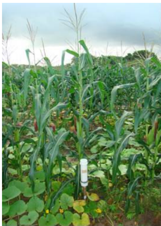
Figura 28 – Disposição de um módulo sensor dentro do plantio de milho.
