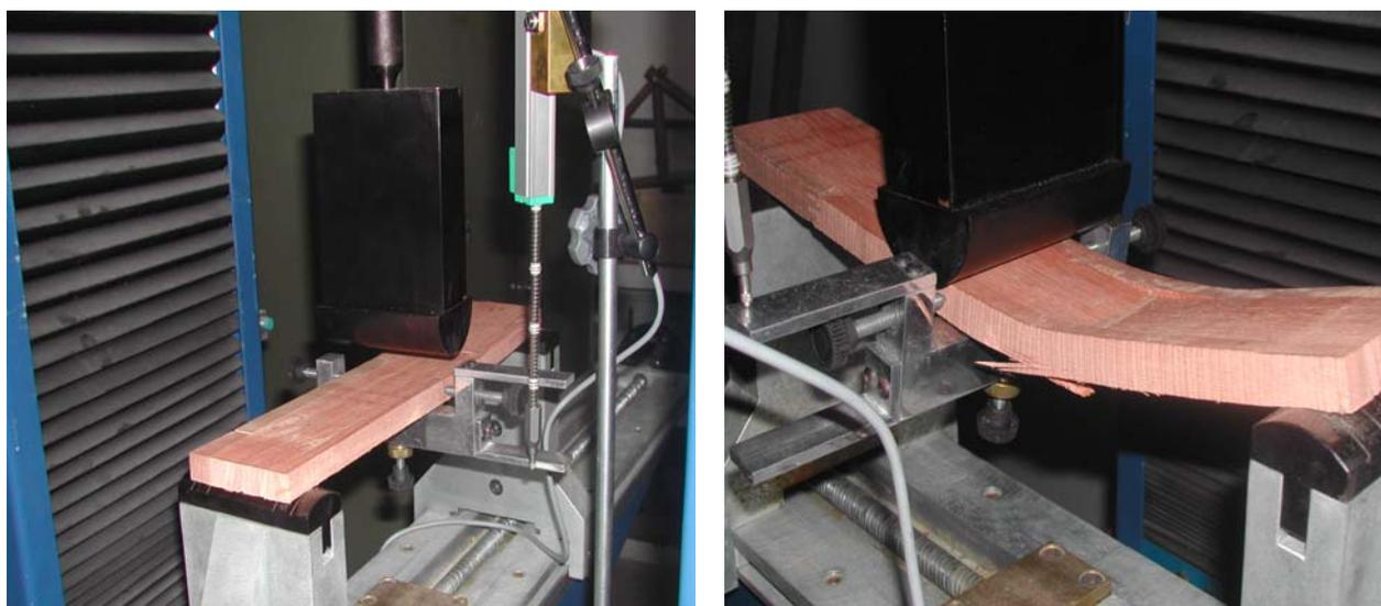
Figura 17. Detalhes dos ensaios de flexão.
