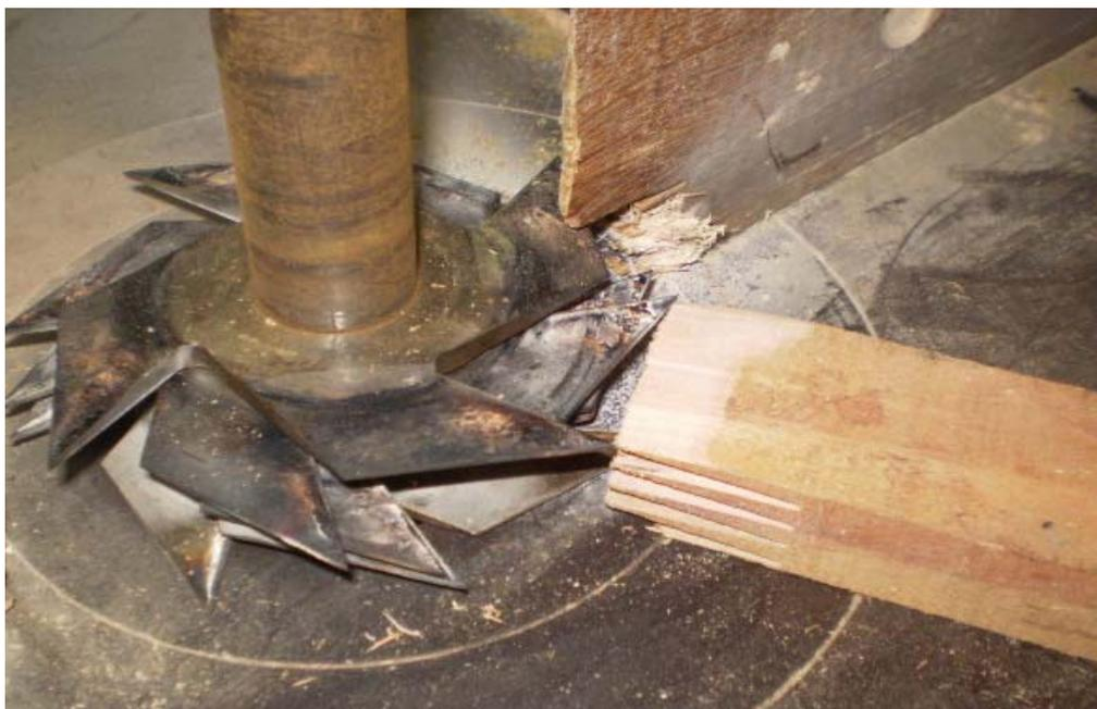
Figura 11. Confeção das emendas do tipo “finger-joint”.
