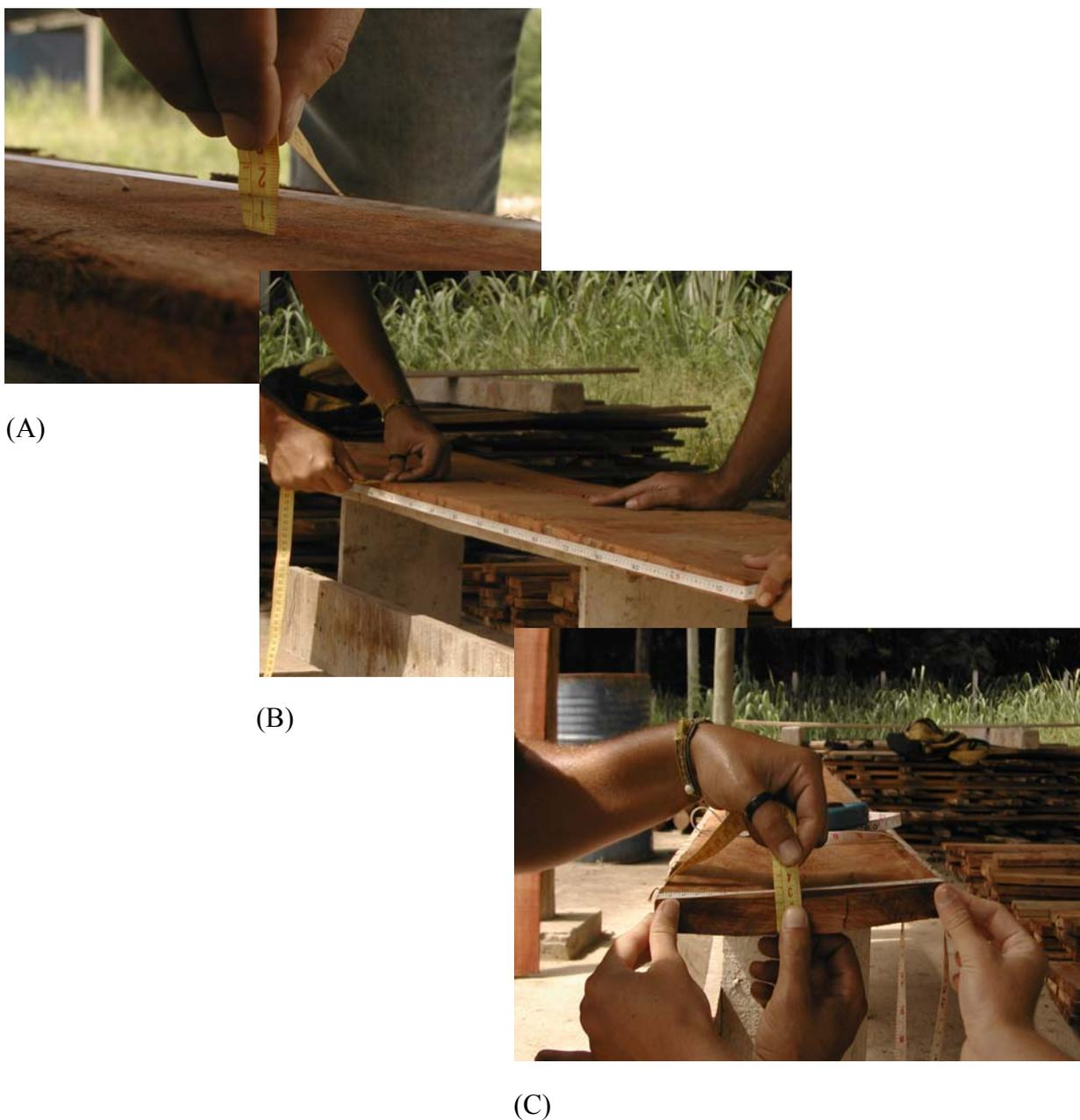
Figura 9. Medições: A - encurvamento; B - arqueamento; C - encanoamento.
