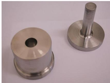
**Figura 4.2** – Matriz cilíndrica de aço inox de 12 mm de diâmetro.
