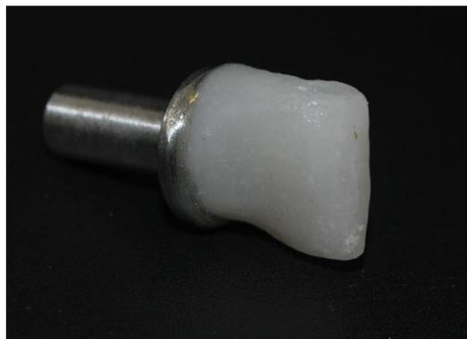
**Figura 4.13** – Pré-forma moldada por injeção a quente colada ao suporte metálico.
