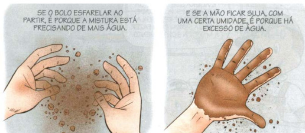
Figura 9 – Observação da umidade da mistura. Fonte: SAHARA (2001).
