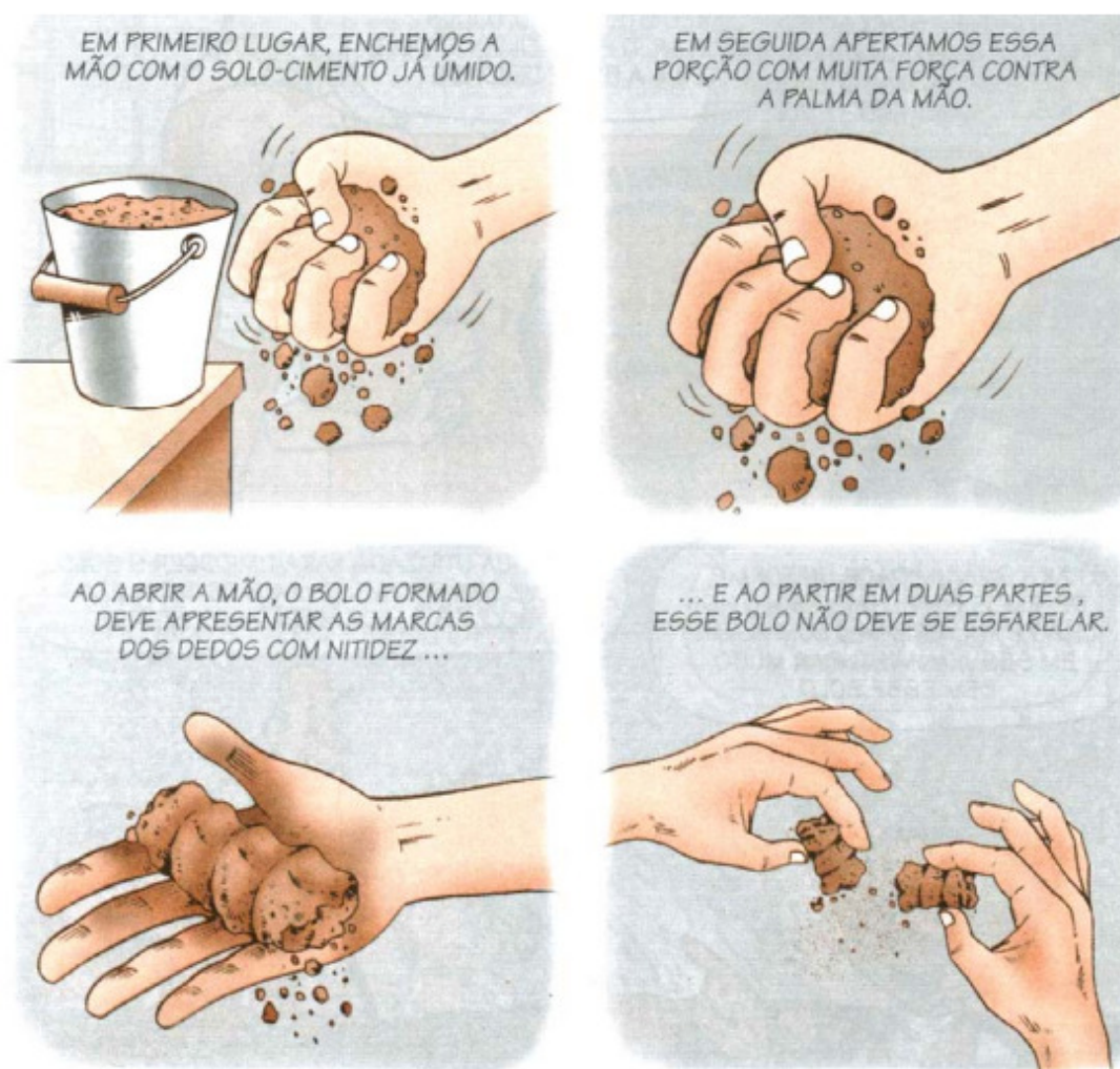
Figura 8 – Observação prática da umidade ótima de compactação. Fonte: SAHARA (2009).
