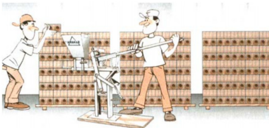
Figura 10 – Produção de tijolos. A máquina deve movimentar-se para perto das pilhas de tijolos, diminuindo o percurso entre a desmoldagem e o empilhamento. Fonte: SAHARA (2009).
