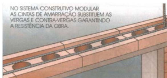
Figura 21 – Detalhes das cintas de amarração e das contra vergas. Fonte: SAHARA (2009).
